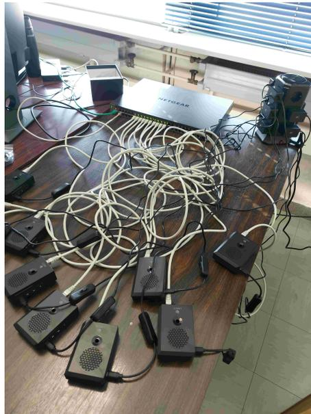
FIGURE 4.3 – Photo du banc d'expérience composé de Raspberry Pi
