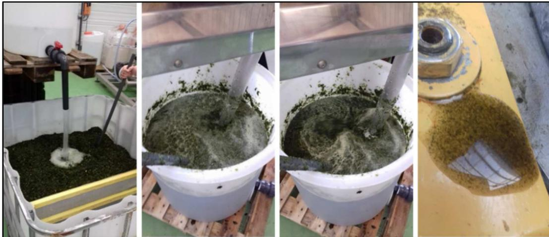
Figure 62 : Etape de broyage de la biomasse algale *Ulva rigida*
