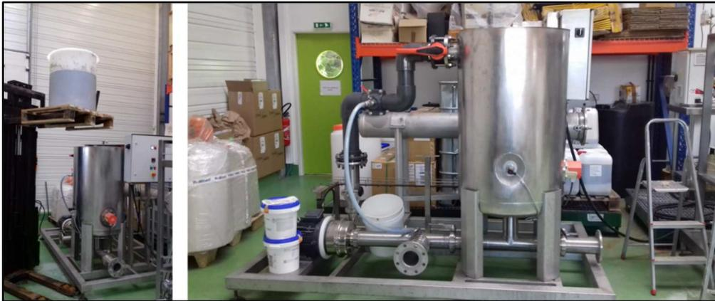
Figure 63: Etape d'extraction de la biomasse algale *Ulva rigida*. Le changement d'échelle a permis de passer d'une cuve d'extraction ayant une contenance de 2 kg à une contenance de 10 kg de biomasse.
