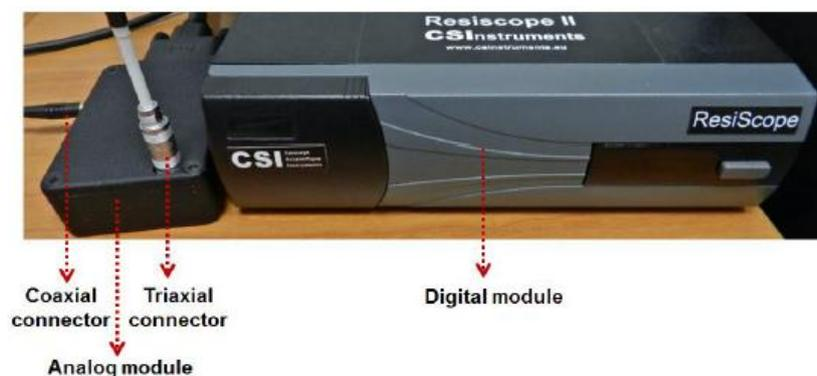
Figure II.7 – Photo des modules digital et analogique du ResiScope [8].
