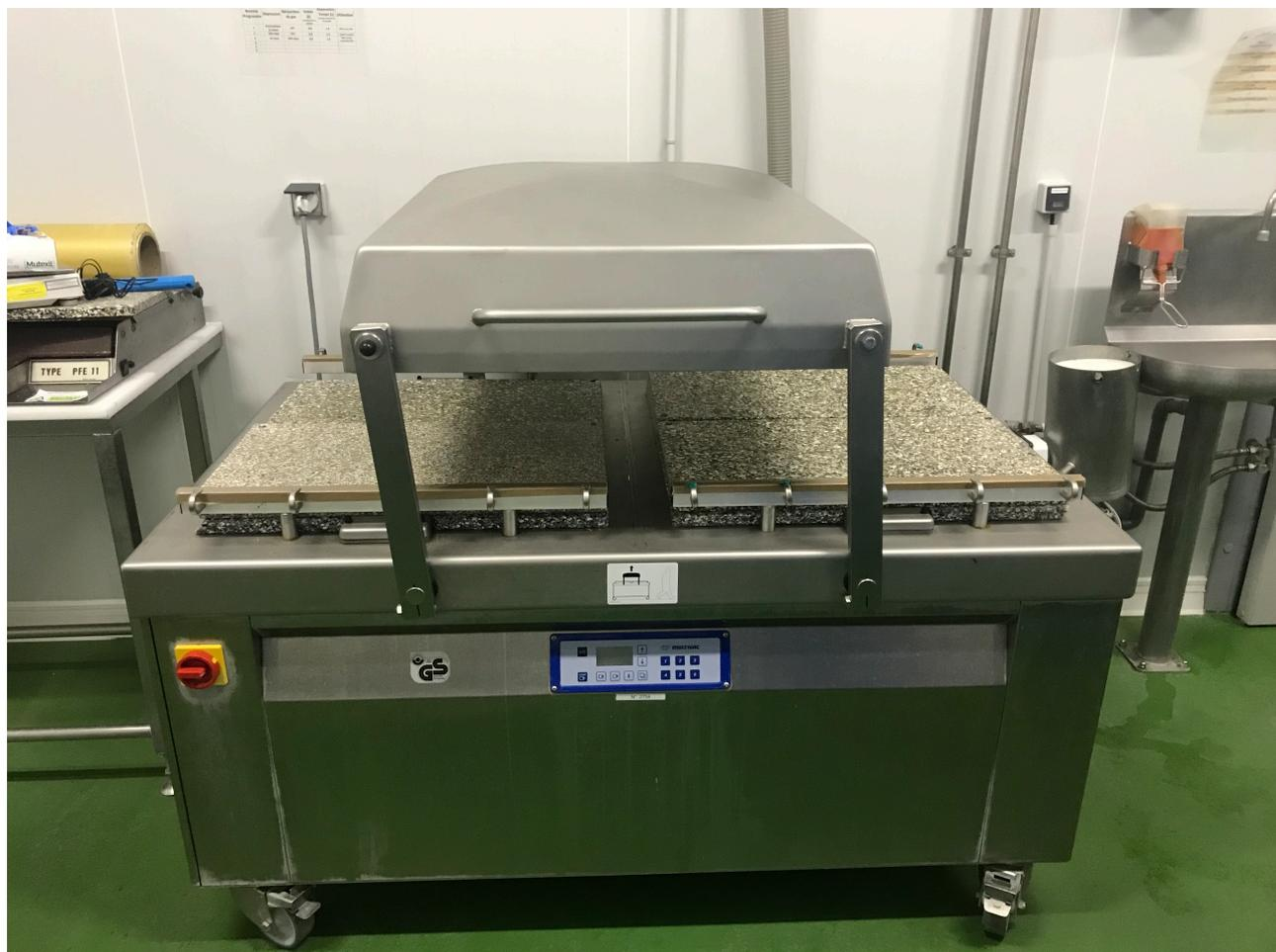
Annexe 15 : Operculeuse semi-automatique Multivac T20 permettant de conditionner les tranches de viande sous atmosphère modifiée (O<sub>2</sub>, N<sub>2</sub> et CO<sub>2</sub>).
