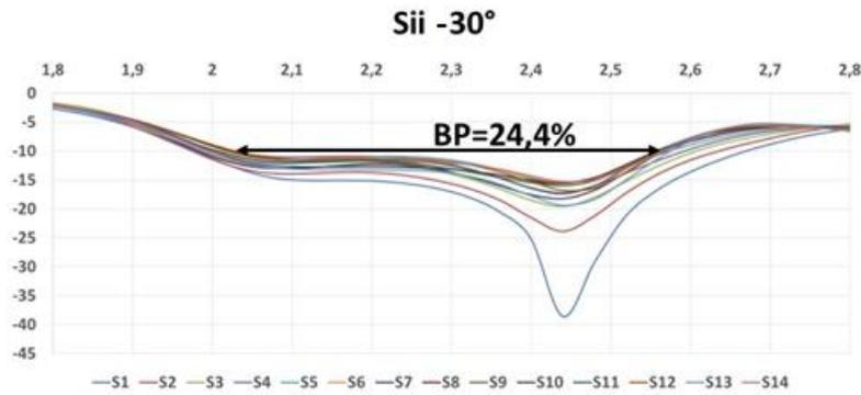
Figure IV. 5: Sii active pour un dépointage de  $-30^\circ$ .
