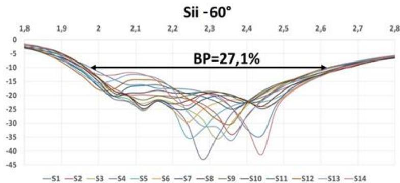
Figure IV. 6: Sii active pour un dépointage de  $-60^\circ$ .
