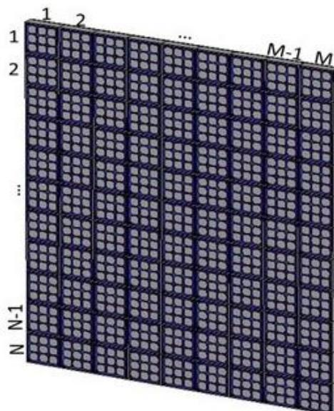
Figure II. 5: Architecture de l'antenne MARPEM 2D.
