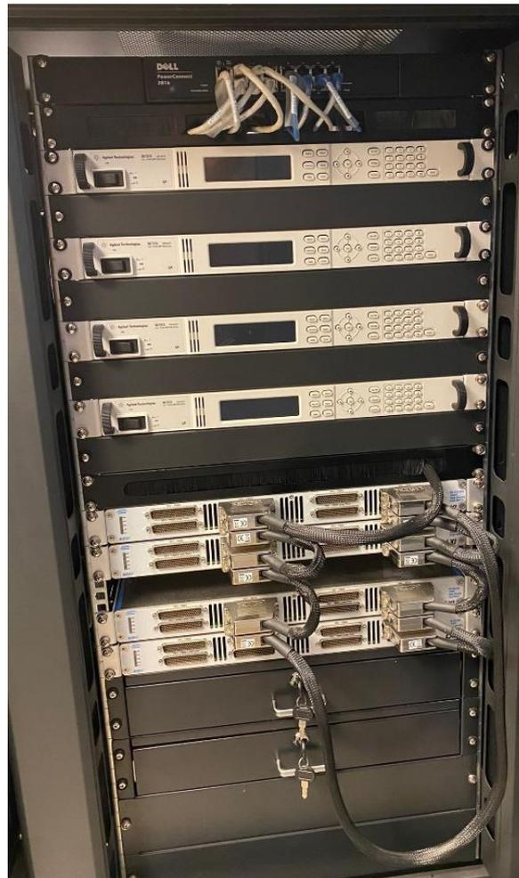
Figure IV. 36: Banc de pilotage et d'alimentation DC multivoies.
