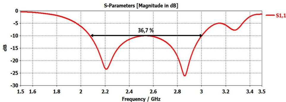
Figure III. 12: Coefficient d'adaptation du pixel large bande.
