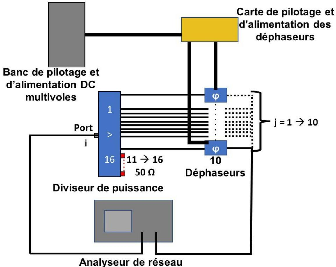
Figure IV. 40: schéma représentatif de la mesure des paramètres S du système d'alimentation.
