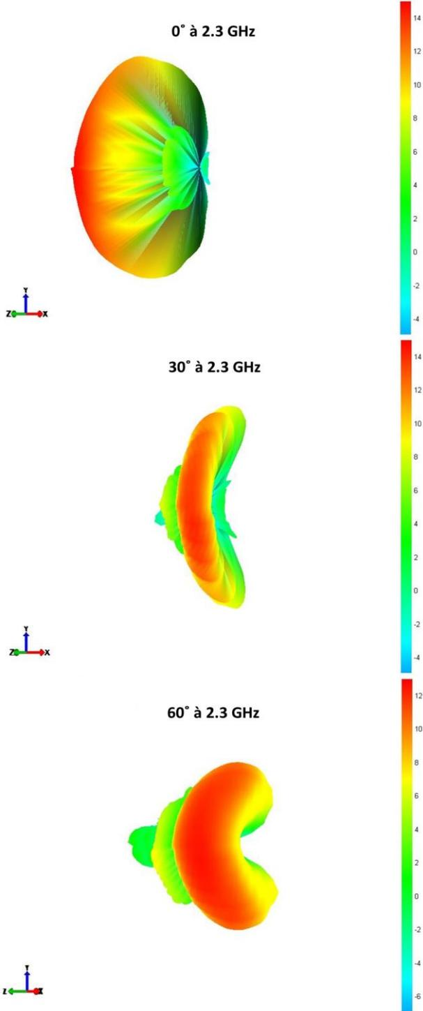
Figure IV. 43: Diagrammes de rayonnements 3D mesurés pour un dépointage de 0°, 30° et 60° à 2.3 GHz.
