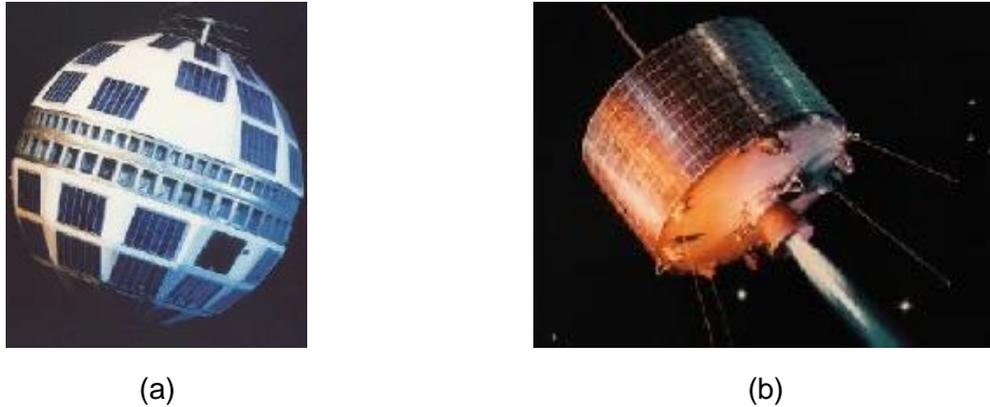
Figure I. 15: Premiers satellites de télécommunications (Telstar et Syncom).
