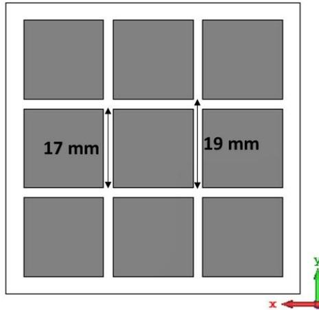
Figure III. 2: Vue de dessous de la PRS formée d'une FSS imprimée sur un substrat Rogers.
