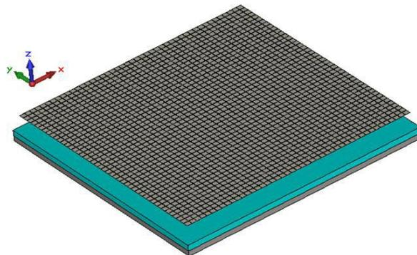
Figure II. 17: Structure d'une antenne BIE a grand gain.
