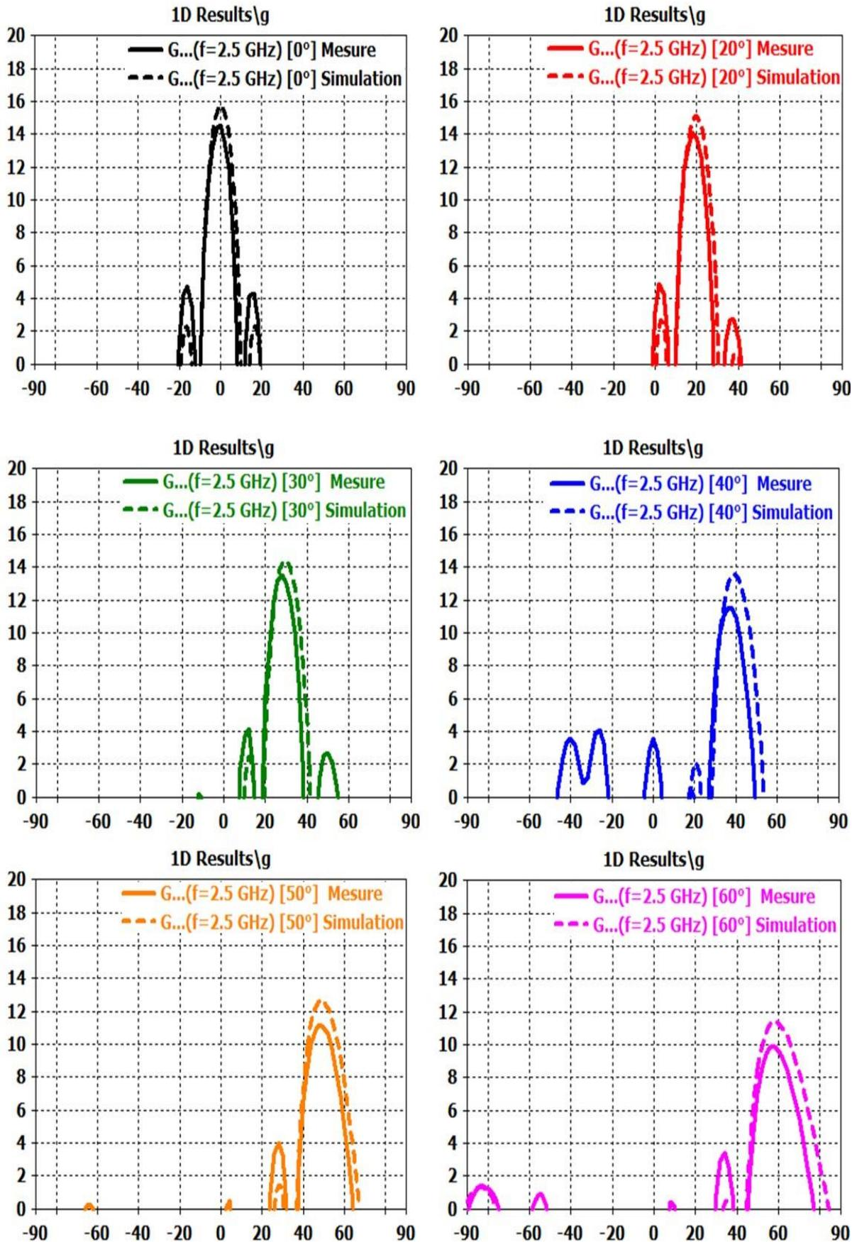
Figure IV. 42: Evolution du gain réalisé mesurés en fonction  $\theta$  dans le plan xoz pour un dépointage de  $0^\circ, 20^\circ, 30^\circ, 40^\circ, 50^\circ$  et  $60^\circ$  à 2.5 GHz.
