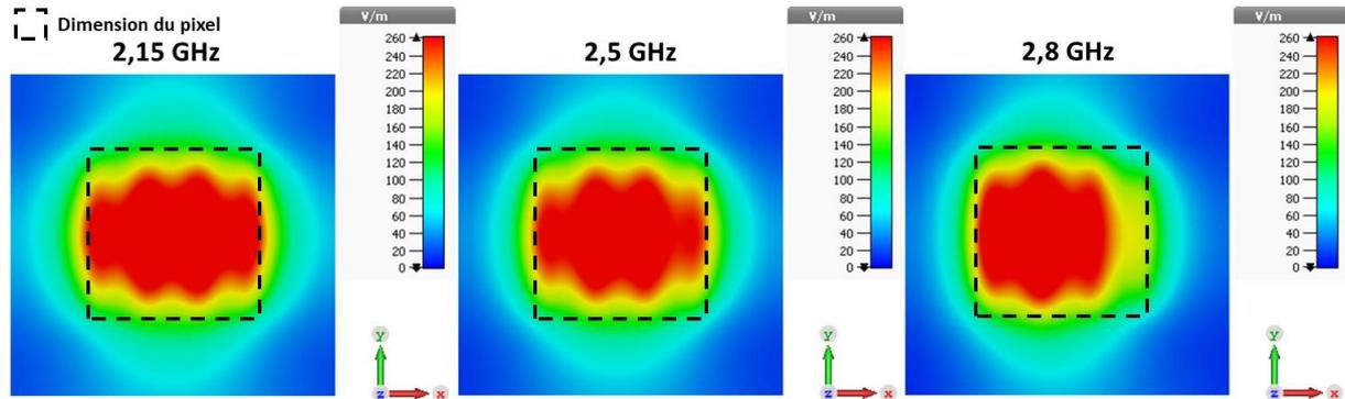
Figure III. 15: cartographies du champs  $E_x$  au-dessus du pixel.
