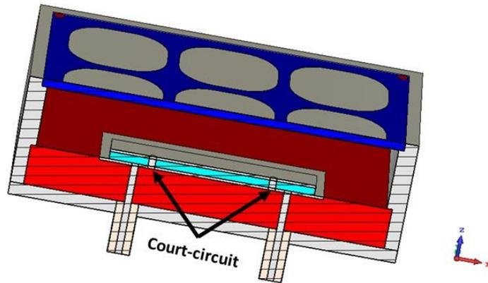
Figure III. 54: Introduction d'un court-circuit.
