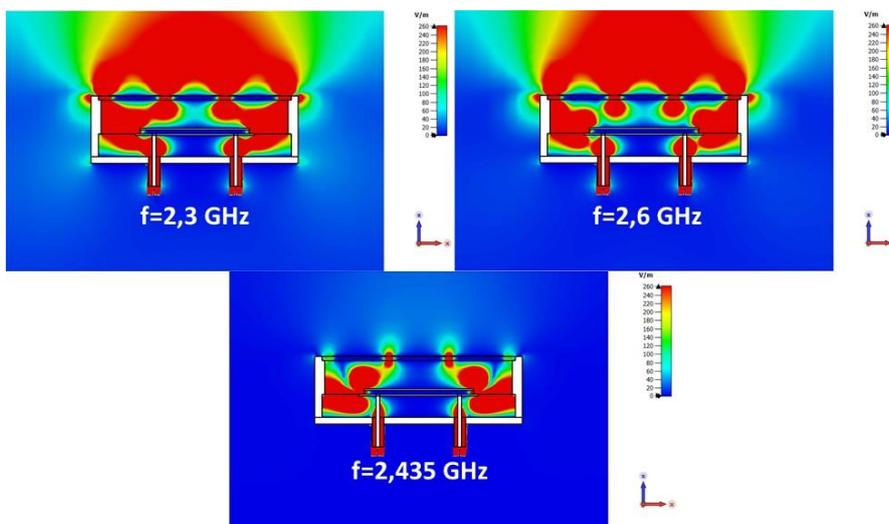
Figure III. 47: Cartographies des champs Ex pour trois fréquences.
