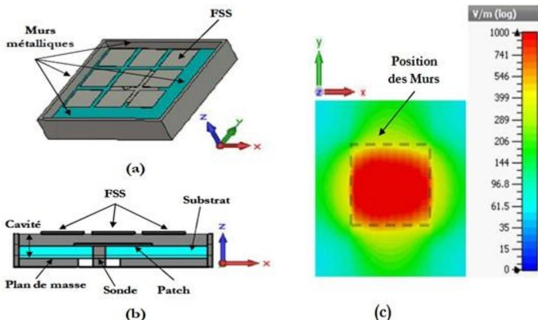
Figure II. 21: Structure finale simple du pixel BIE (a) vue en perspective (b) vue en coupe suivant la largeur (au milieu de  $0y$ ) et (c) Cartographie du champ électrique sur la surface supérieure de pixel.
