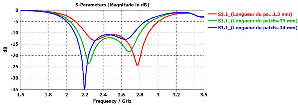
Figure III. 10: Coefficient d'adaptation S11 pour différentes longueurs du patch.
