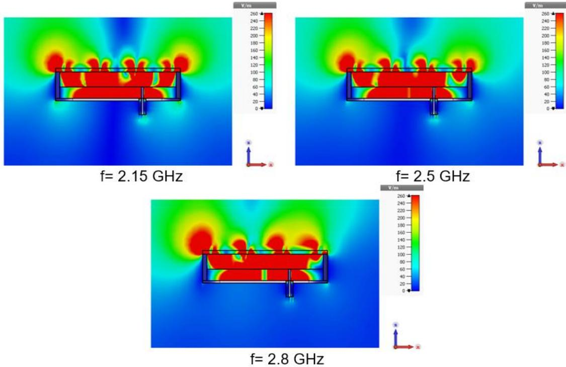
Figure III. 19: Cartographies du champ  $E_z$  pour plusieurs fréquences selon  $xoz$ .
