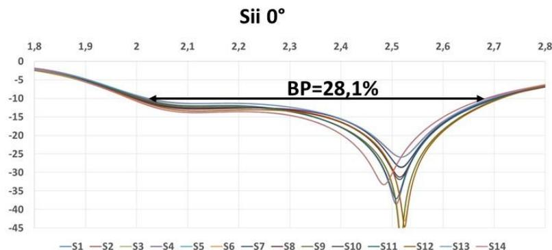
Figure IV. 4: Sii active pour un dépointage de  $0^\circ$ .
