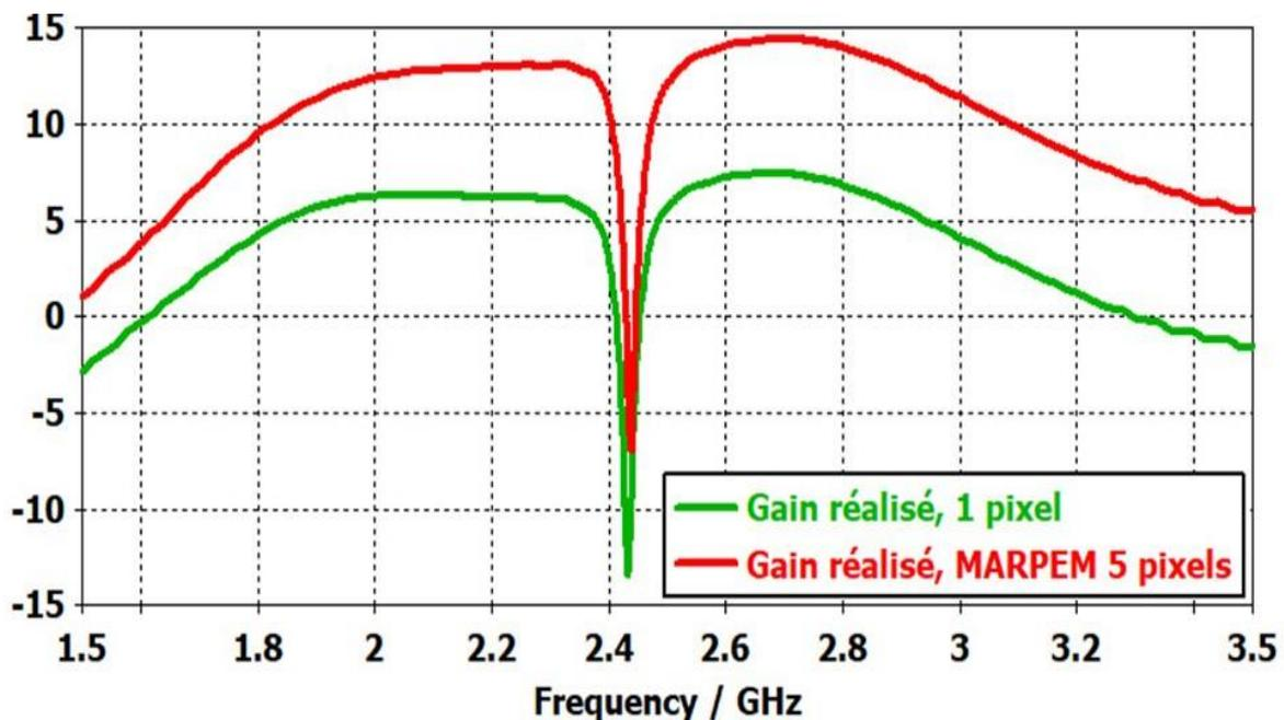
Figure III. 53: Gain réalisé du pixel et de MARPEM en fonction de la fréquence.
