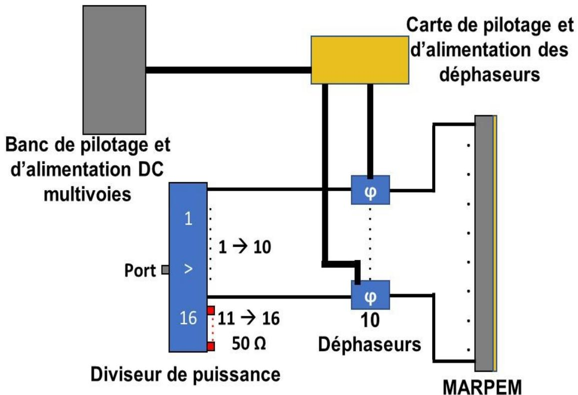
Figure IV. 32: Schéma représentant le système d'alimentation de l'antenne fabriquée.
