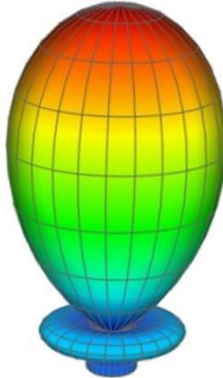
Figure I. 3: Diagramme de rayonnement 3D d'une antenne directive.
