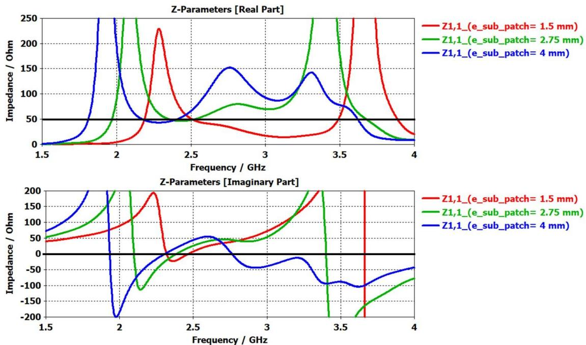
Figure III. 6: évolution de la partie réelle et imaginaire de l'impédance en fonction de la fréquence pour différentes épaisseurs du substrat du patch.
