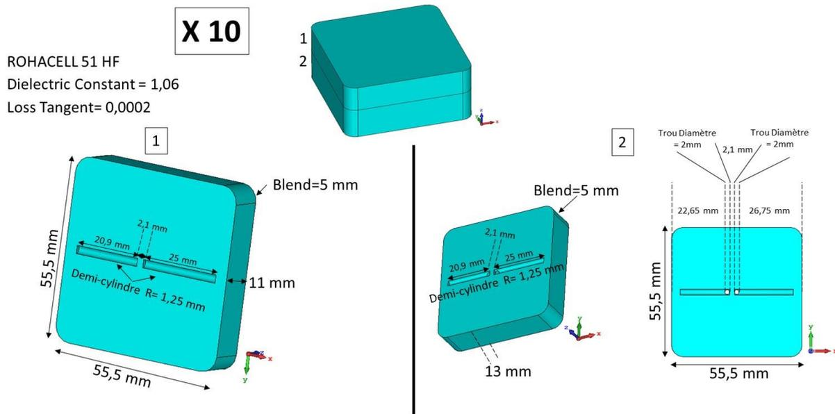
Figure IV. 26: géométrie des plaques de rohacell fabriquées.
