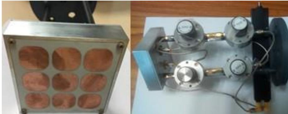
Figure III. 39: Pixel 1 port et Pixel 2 ports fabriqués.
