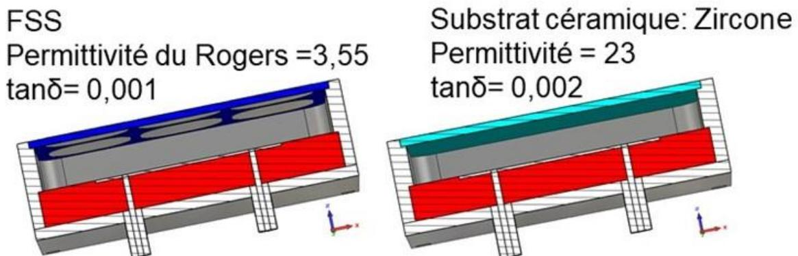
Figure III. 36: Structures générales des Pixels avec différent PRS.
