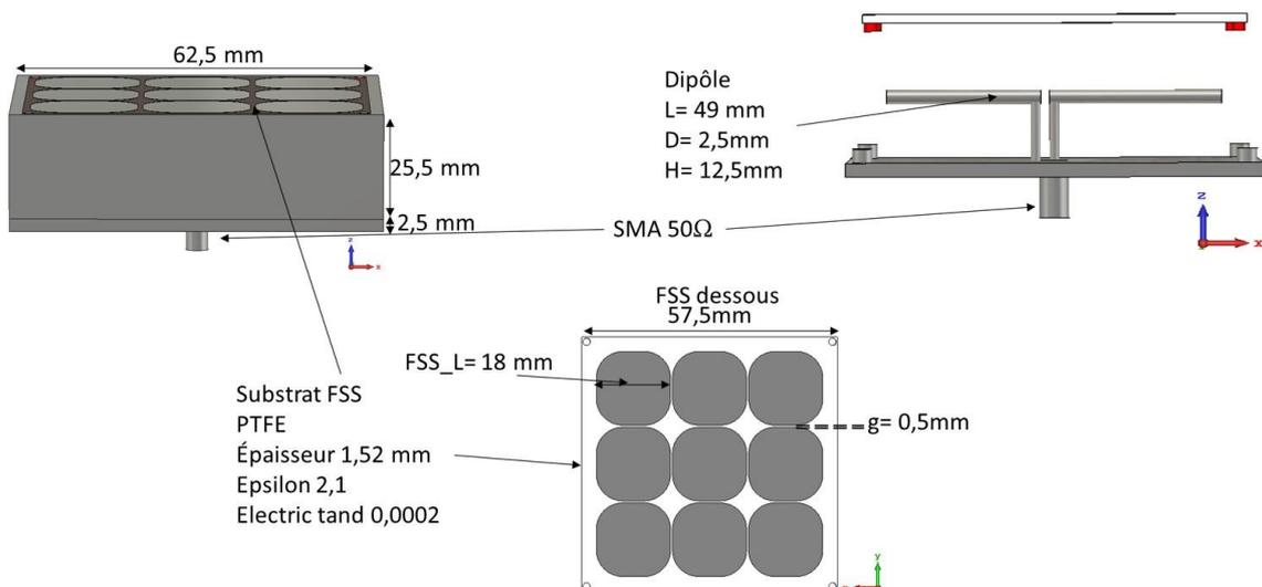
Figure IV. 12: Structure d'un Pixel réduit de l'antenne MARPEM.
