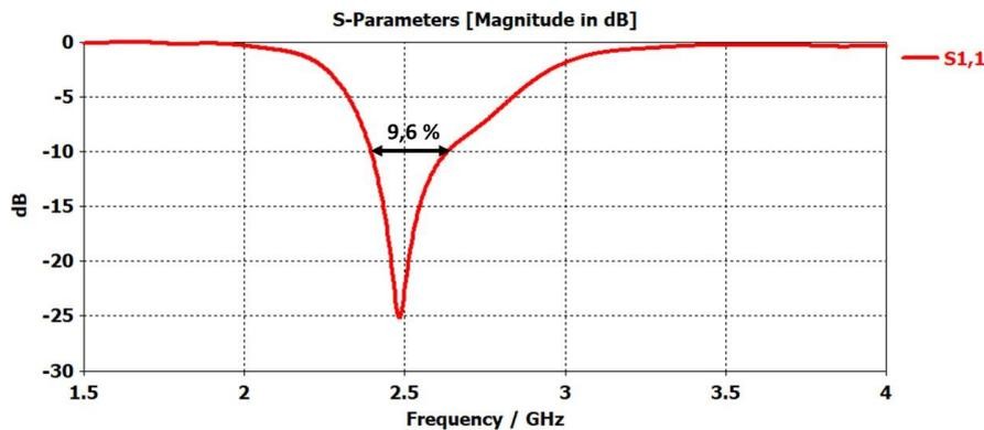
Figure III. 4: Coefficient d'adaptation  $S(f)$ .
