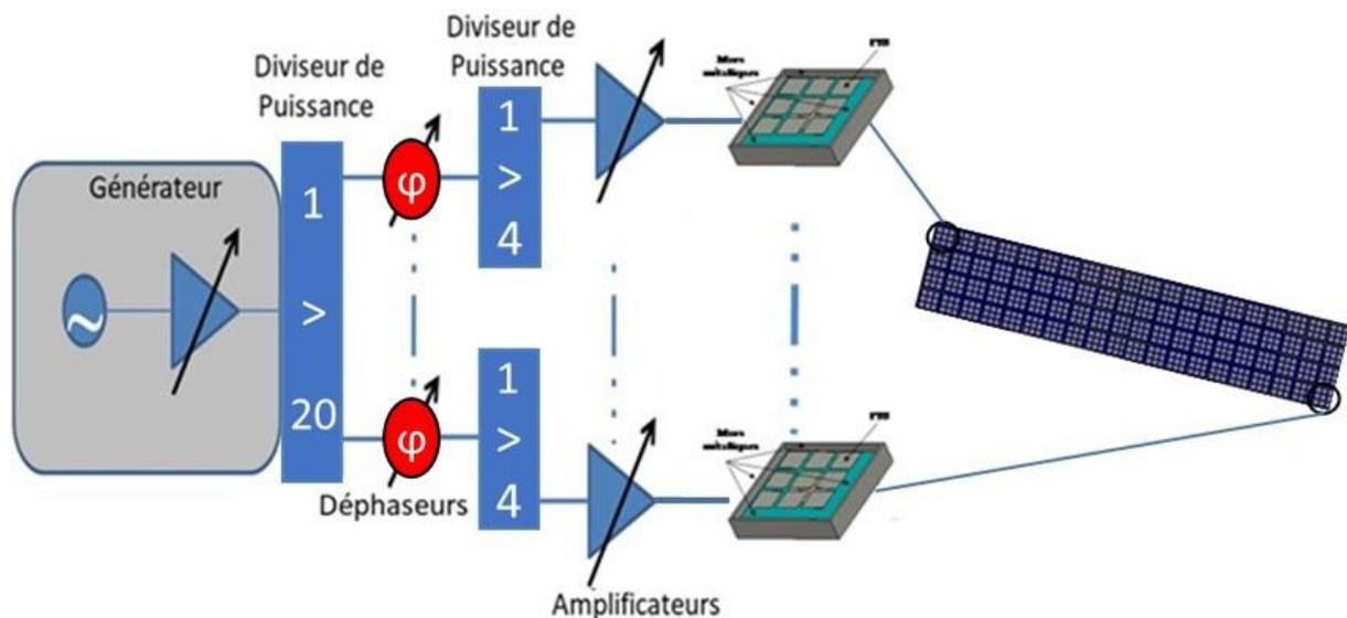
Figure V. 18: Structure générale du système pour un amplificateur par pixel.
