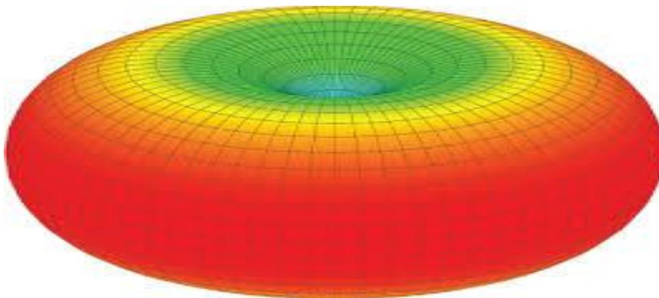
Figure I. 9: Rayonnement 3D d'une antenne omnidirectionnelle.
