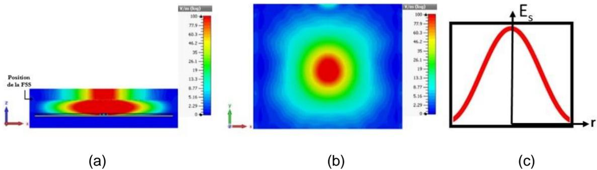
Figure II. 18: (a) Cartographie du champ électrique vue en coupe suivant la largeur (au milieu de  $0y$ ) (b) Cartographie du champ électrique  $E_s$  vue au-dessus de l'antenne (c) Distribution du champ selon  $r$ .
