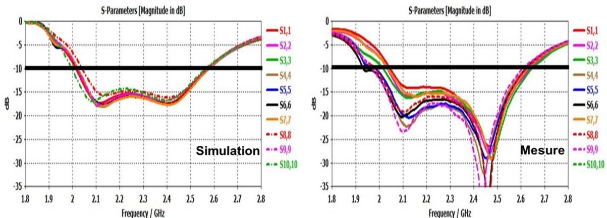
Figure IV. 30: Coefficients d'adaptation passifs simulés et mesurés.
