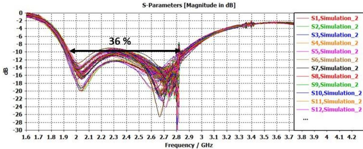
Figure III. 60: Evolution des paramètres des pixels  $S_{ij}$  en fonction de la fréquence pour tous les pixels. Le coefficient d'adaptation est inférieur à -10 dB sur une large bande passante de l'ordre de 0.85 GHz qui est équivalente à 36%. (Figure III.60).
