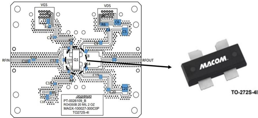
Figure V. 5: L'amplificateur MAGX-100027-300C0P.
