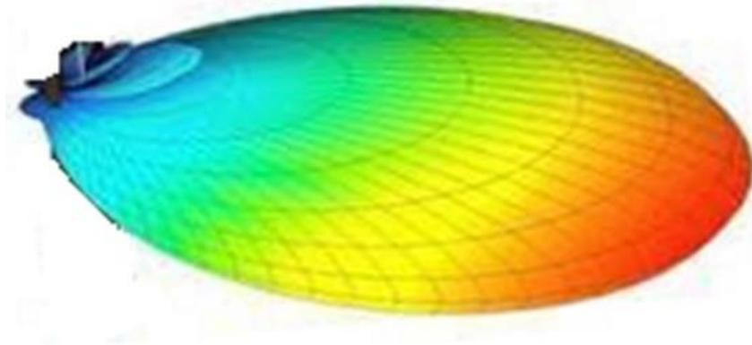
Figure I. 6: Diagramme de rayonnement 3D d'une antenne sectorielle.
