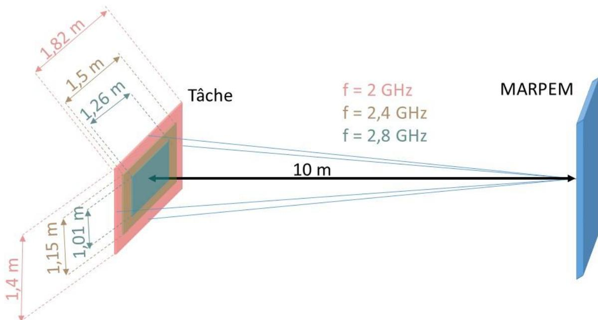
Figure V. 11: dimensions des tâches pour plusieurs fréquences.
