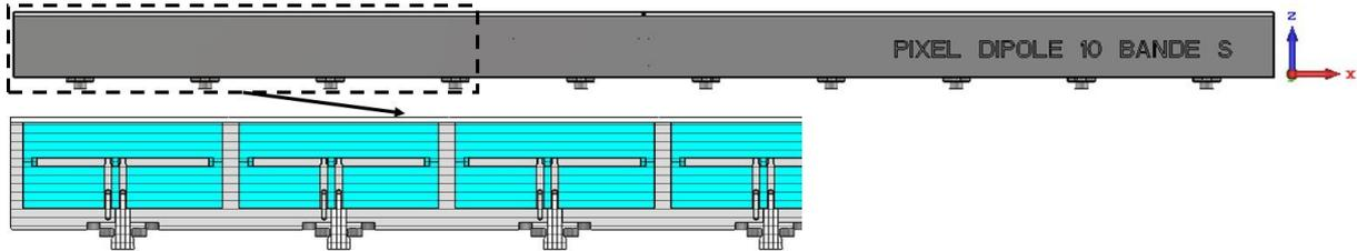
Figure IV. 21: structure générale de l'antenne MARPEM 1D fabriquée.
