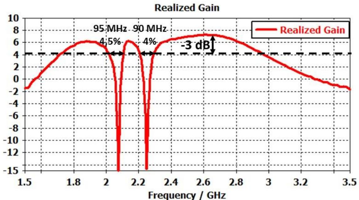
Figure III. 58: Evolution du gain réalisé en fonction de la fréquence d'un pixel ULB alimenté par 3 patchs adaptés pour protéger le lien spatial du transpondeur.
