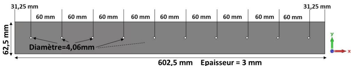
Figure IV. 23: géométrie du plan de masse fabriqué.
