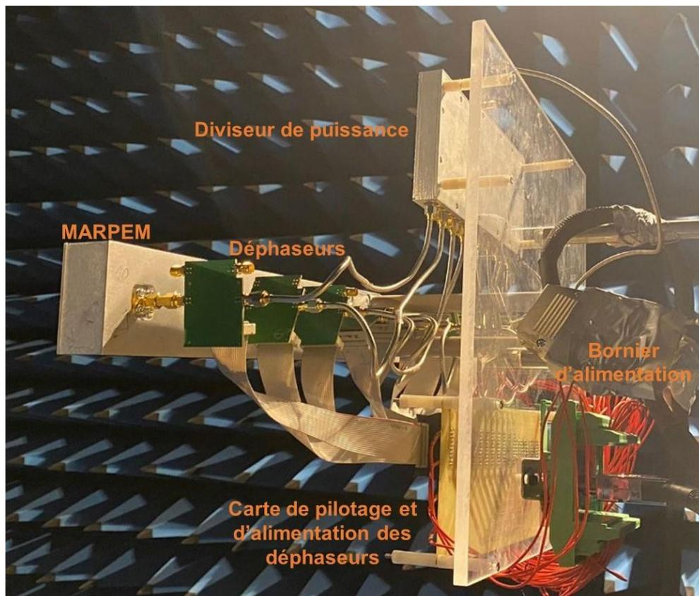
Figure IV. 38: MARPEM fabriqué + système d'alimentation.
