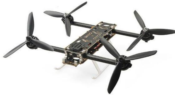
FIGURE 1.14 – Exemple de quadrotor avec tilt-rotors
