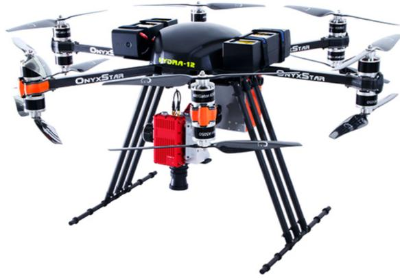
FIGURE 1.8 – Exemple de drone hexa-rotor à double hélice
