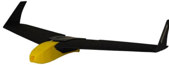
FIGURE 1.12 – Exemple de drone à voilure fixe sans rotor (CAM-FLYERG)
