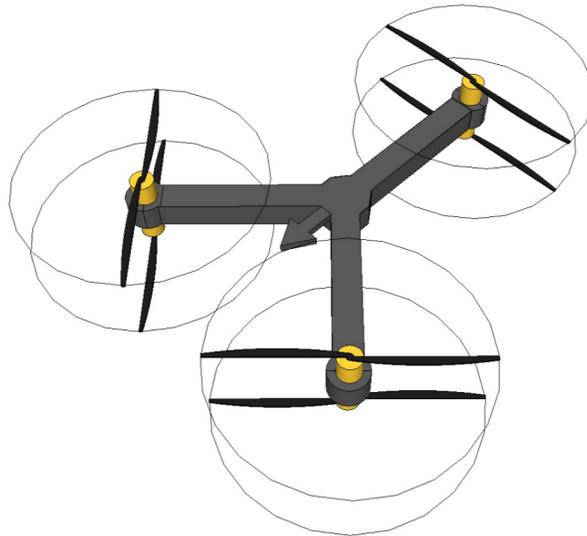
FIGURE 1.5 – Schéma de drone tri-rotor à double hélice
