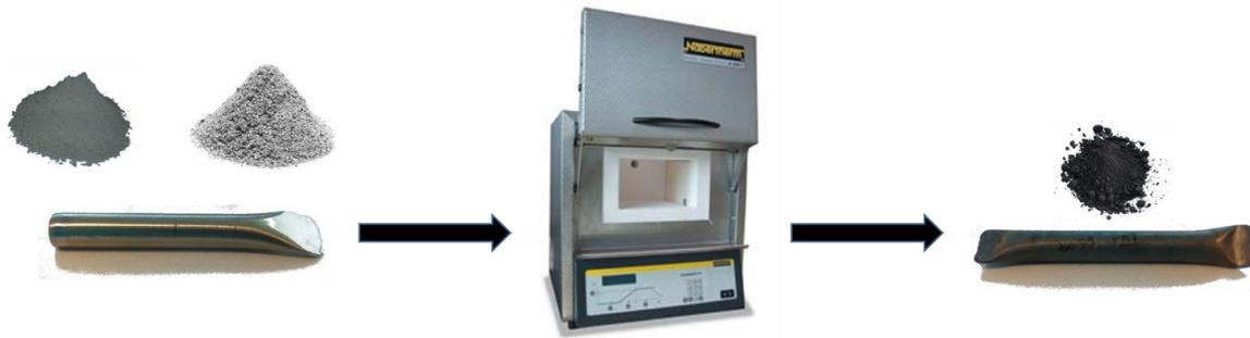
*Figure 40 : Synthèse de  $MgB_2$  par la méthode des tubes scellés.*
