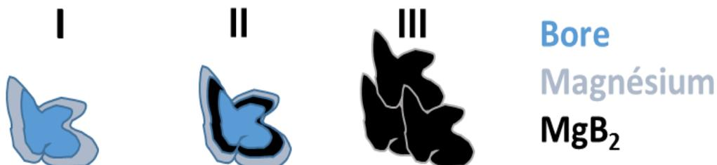
Figure 45: Représentation schématique de la réaction d'une particule de bore avec Mg lors de la formation de  $MgB_2$
