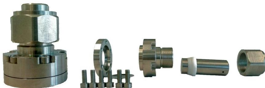
*Figure 27: Cellule LeRiChe'S de diffraction des rayons X utilisée pour l'étude de poudres sensibles à l'air.*
