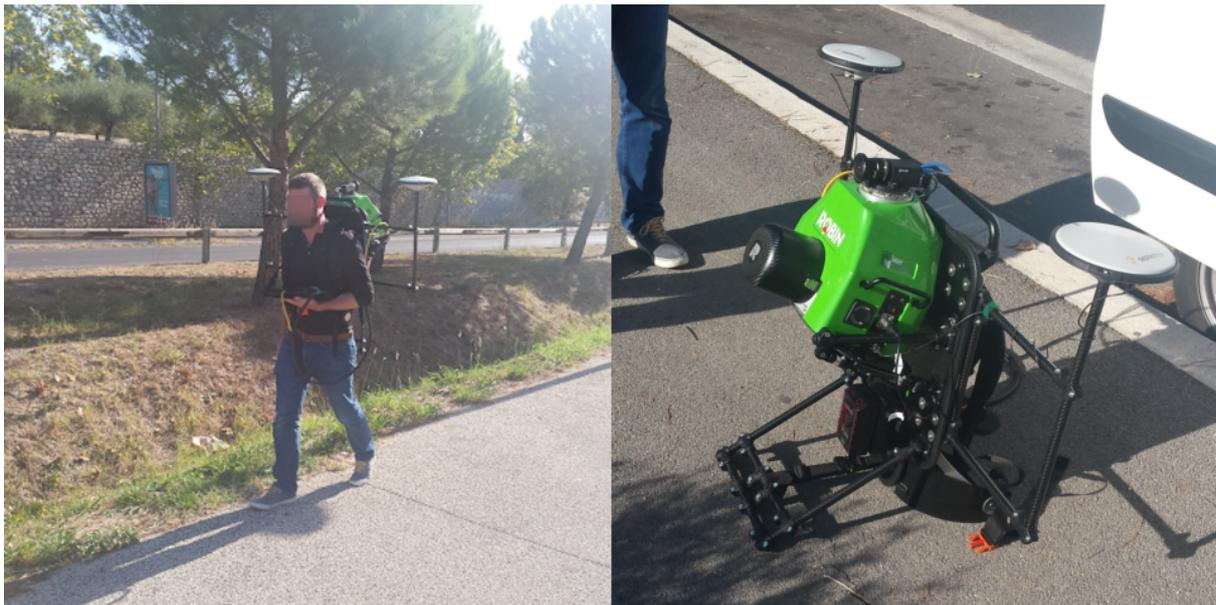
FIGURE 49 – Photos de l'appareil 3D laser mapping Robin monté sur un sac à dos, pendant l'acquisition à gauche et isolé à droite.
