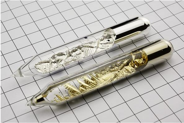
**Figure 6.8** – Cristaux métalliques de rubidium (au-dessus) et de césium (en dessous) scellés dans des ampoules sous vide. Ces matériaux sont ignorés par notre méthode actuelle car leur indices valent respectivement  $\tilde{\eta}_{Cs} \in [0.53 + 0.32i, 0.28 + 1.7i]$  et  $\tilde{\eta}_{Rb} \in [0.19 + 0.37i, 0.11 + 1.98i]$  entre les longueurs d'onde 380nm et 780nm (mesures de Smith [Smi70]). Source : [commons.wikimedia.org](https://commons.wikimedia.org), propriété de ErpingWu.
