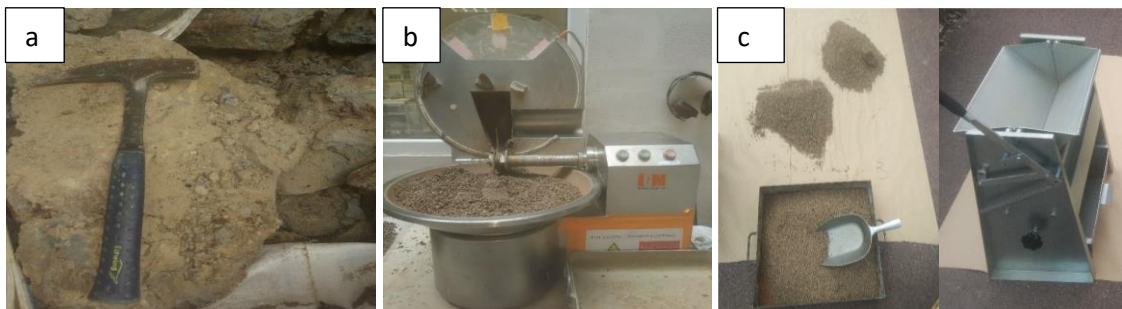
Figure 26: a) Bloc d'argile fractionné au marteau b) Malaxeur à couteau c) Diviseur d'échantillons par quartage
