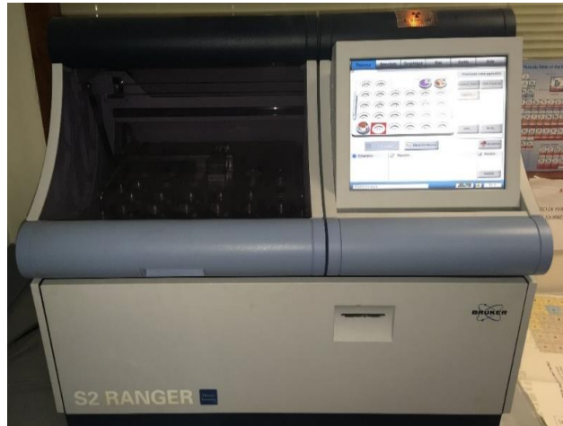
Figure 34: spectromètre à fluorescence X BRUKER S2 RANGER (IRC)
