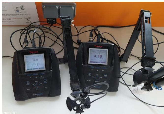
Figure 41: pH-mètre et conductimètre de paillasse
