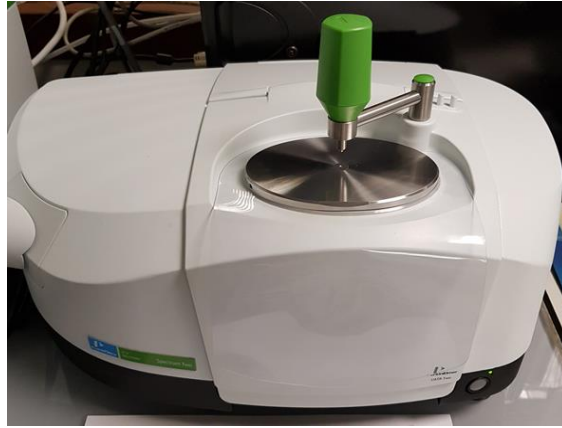
Figure 37: Spectromètre FTIR, Spectrum Two
