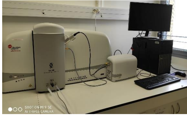
Figure 31: Granulomètre Laser, BECKMAN COULTER
