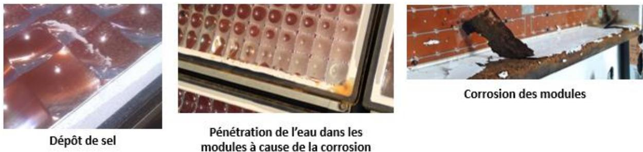
Figure III. 37: L'impact de la corrosion sur les modules CPV sur le site d' Ajaccio
