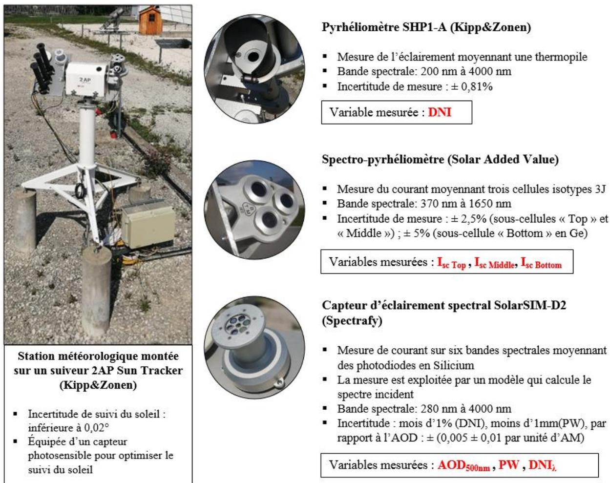
Figure III. 24: La mesure de l'éclairement et du spectre incident sur le site du Bourget du Lac
