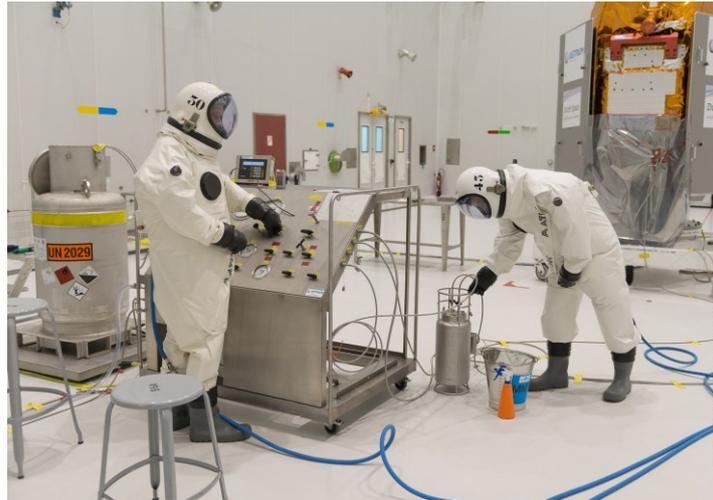
*Figure 1.15 : Manipulation en scaphandre pour les ergoliers (image Arianespace)*
