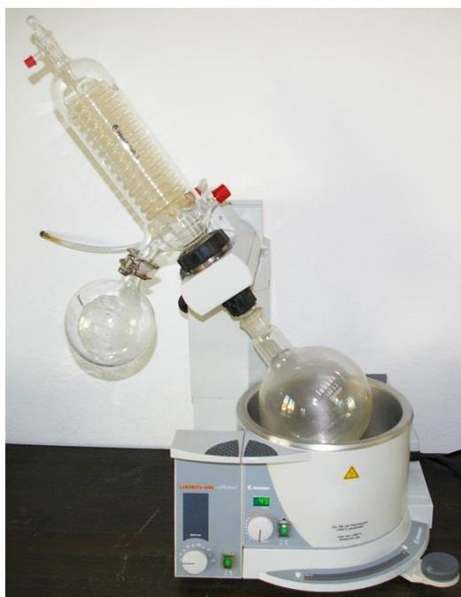
**Fig.II.15** : Evaporateur rotatif LABOROTA 4000
