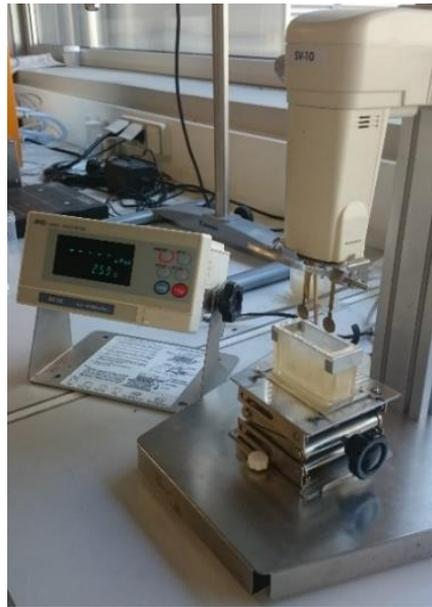
**Fig.II.7 :** Viscosimètre à vibration
