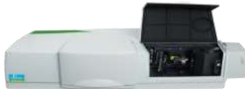
Figure II.18 : Spectrophotomètre UV-Vis-NIR utilisé.
