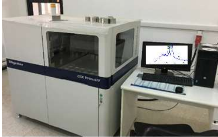
Figure II.11 : Spectromètre à Fluorescence X type Rigaku ZSX PrimusIV.
