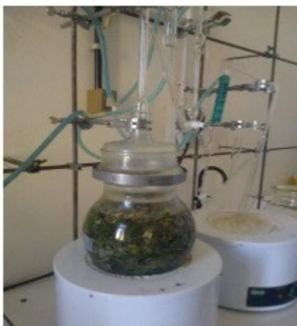
Figura 25: Apparecchiatura tipo Clavenger
