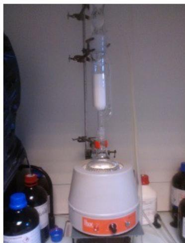
Figura 30: Apparecchiatura Soxhlet
