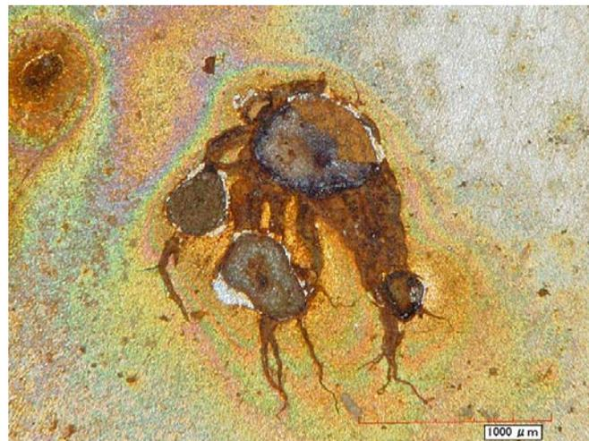
*Figure 67: Images réalisées au microscope optique d'une attaque par corrosion localisée, avec un effondrement partiel de la voûte de produits de corrosion, sur un échantillon d'acier API 5L X65 polarisé jusqu'au potentiel de piqûre puis laissé à l'abandon 200 heures dans 0,5 M  $\text{NaHCO}_3$  + 0,2 M  $\text{NaCl}$  – test J*
