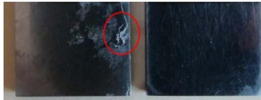
Figure 99: Photos des deux échantillons du test 7 ( $S = 7,5 \text{ cm}^2$  cataphorèse) après 97 heures d'immersion dans une solution de  $0,5 \text{ M NaHCO}_3 + 0,2 \text{ M NaCl}$  et après décapage des produits de corrosion
