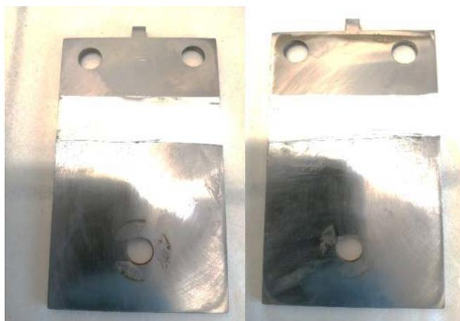
Figure 79: Macrographies des deux faces de l'échantillon du test 11 après 90 heures d'immersion dans 0,5 M  $\text{NaHCO}_3$
