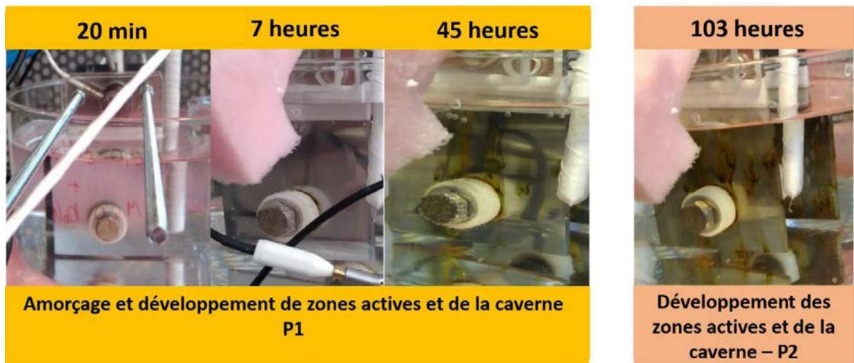
*Figure 80: Présentation de l'aspect d'un échantillon du test 14 à différents temps d'immersion*
