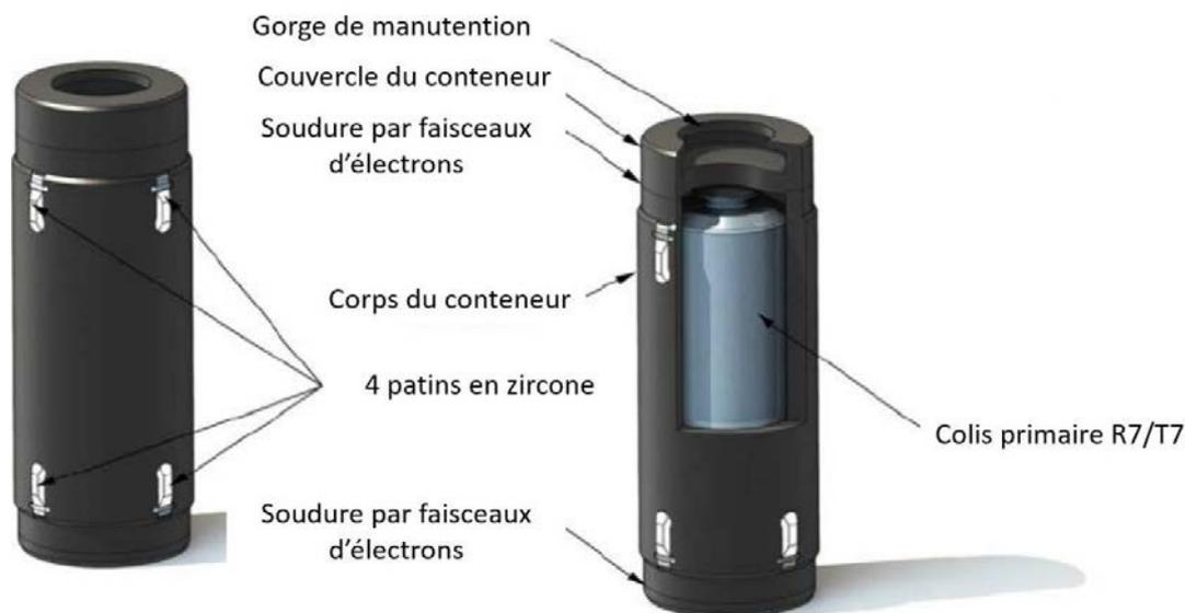
*Figure 4: Schématisation des colis de stockage des déchets HA [11]*
