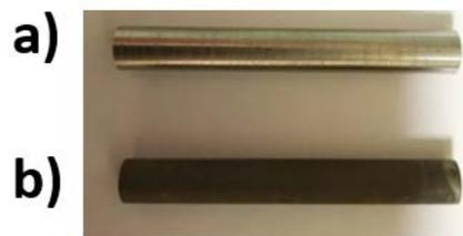
*Figure 125: Photos d'un échantillon d'acier API 5L X65 a) après usinage et b) après 100 heures d'immersion dans 2 g.L<sup>-1</sup> NaCl, 0,54 bar CO<sub>2</sub>, 80°C, pH 7 – 7,1*
