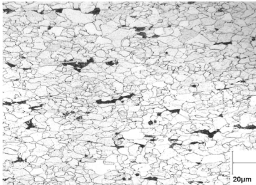
*Figure 33: Microstructure ferritique avec fines plages de perlite de l'acier API 5L X65*
