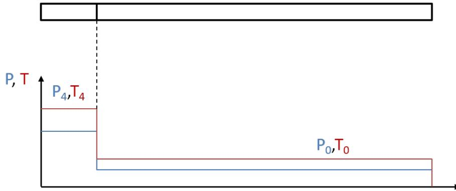
FIGURE 2.9 – Répartition des grandeurs thermodynamiques dans le tube à l'état initial.
