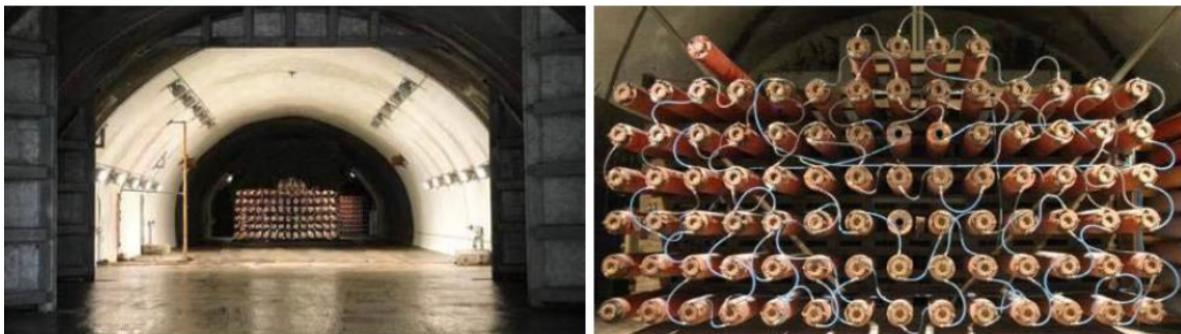
FIGURE 2.3 – Tube à choc de WTD 52 et arrangement typique de bouteille. (Issu de [12])
