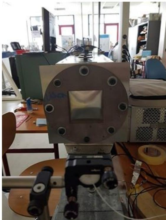
FIGURE 2.26 – Plaque de 0.5mm ayant plastifié au fond du tube à choc.
