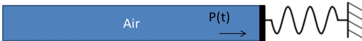
FIGURE 4.1 – Modélisation d'une structure par piston équivalent
