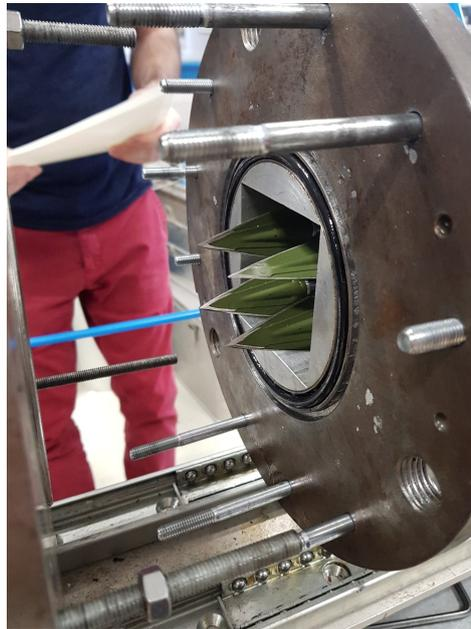
FIGURE 2.27 – Poinçons servant à la rupture mécanique du diaphragme.
