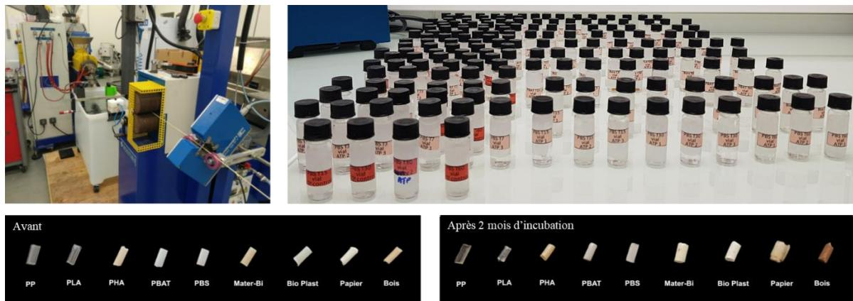
*Figure 30 : Présentation de la ligne complète de production de tiges des différents polymères (à gauche) et des tubes à essai ayant servi à l'incubation en milieu minimum (à droite). Les morceaux de tiges de 0,5 cm et de différentes compositions chimiques sont illustrées avant et après 2 mois d'incubation (en bas).*
