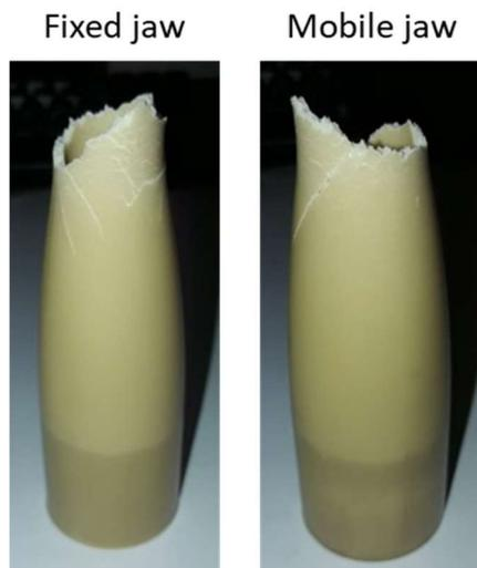
Figure 2-39 : Photographies des deux morceaux d'une éprouvette tubulaire en PA66GF50 rompue après essai de fatigue en traction à  $R=0$  et à T80RH50
