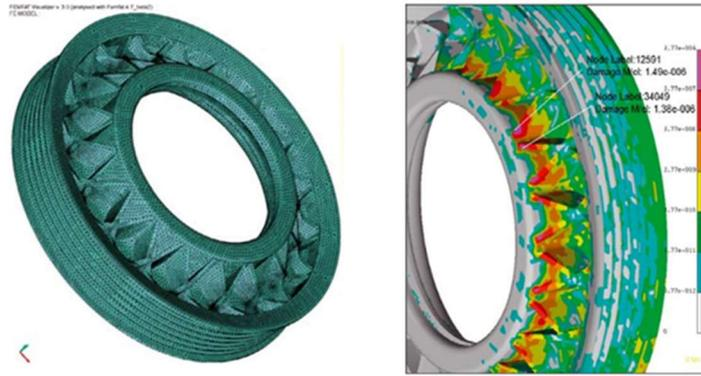
Figure 1-32 : Maillage sur une poulie et distribution du dommage en fatigue simulé par FEMFAT suite à un calcul éléments finis sur une structure de poulie en PA6GF40 [Gaie10]
