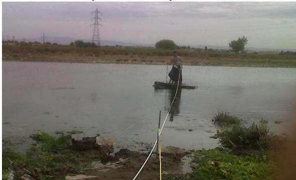
**Photo 45: Exploration du champ des vitesses dans l'amont de l'oued Fès. (12 Sept. 2014)**
