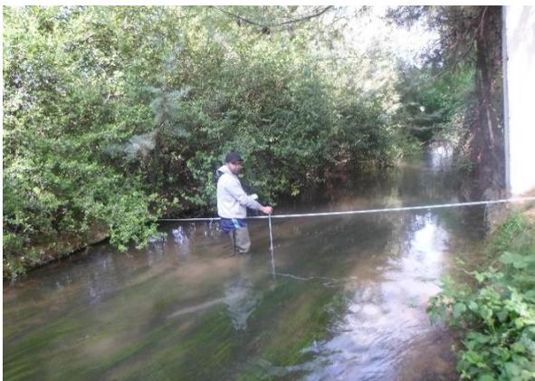
**Photo 41: Exploration du champ des vitesses dans une section naturelle, source Ribaa aval. (29 fév., 2016)**
