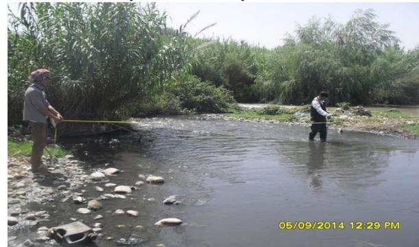
**Photo 46: Exploration du champ des vitesses dans l'amont de l'oued Fès. (5 sep. 2014)**
