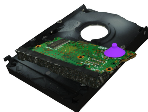
Figure 1 – Illustration de l'utilisation du modèle de ventouse dans le cadre du projet Imagine: les différentes actions de démantèlement d'un disque dur sont simulées, en utilisant notamment une ventouse fixée à l'extrémité d'un bras de robot. Les simulations sont issues des travaux réalisés pendant la thèse.
