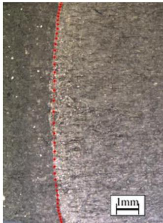
Figure 124: Comparaison entre les résultats numériques en utilisant la méthode de  $\Delta\varepsilon_{p22}$  et les résultats expérimentaux pour  $\Delta K=4\text{MPa}\sqrt{\text{m}}$ ;  $R=0,7$
