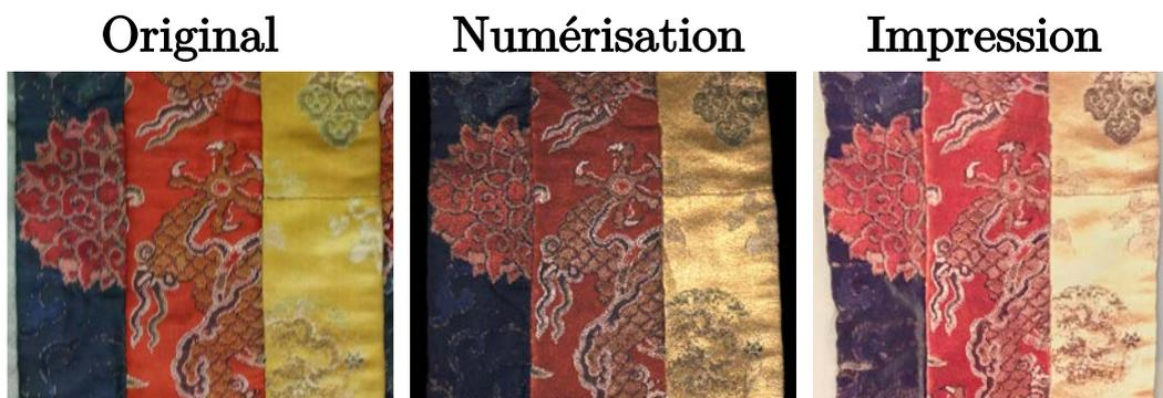
FIGURE 5.56 – Premier succès en impression 2,5D. L'essai a été réalisé sur un morceau du *gilet de mariée*, échantillon d'une taille 15 cm × 15 cm, et montre une concordance encourageante. Les couleurs ne sont pas comparables car les conditions d'éclairage sont très éloignées.
