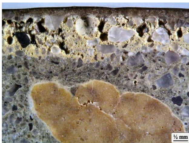
Figure I-2 : Vue en coupe sous microscope de l'attaque acide de la pâte cimentaire [Pabalan – 2011]
