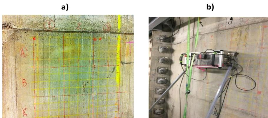
Figure V-17 : a) Zone sans fissure T2 quadrillée choisie pour le contrôle non destructif des techniques proposées par le projet ENDE (les positions des mailles :  $y = \{A,B,C\}$ ,  $x = \{1,2,3\}$ ) ; b) le scanner HF en fonctionnement sur la zone choisie
