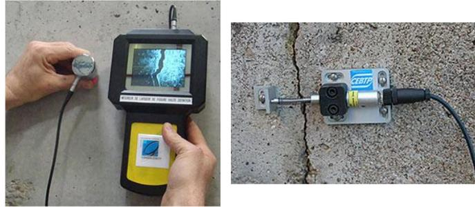
Figure V-1 : [gauche] Exemple de mesure optique de l'ouverture d'une fissure ; [droite] exemple de suivi de l'évolution d'une fissure grâce à un capteur potentiométrique
