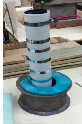
Figure IV-6 : a) 14 tranches d'un même cylindre de calcaire prélevé sur le 2<sup>ème</sup> bloc ; b) imbibition de 1 cm d'eau sur la colonne de tranches réassemblées
