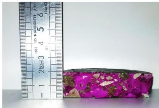
Figure II-17 : 2<sup>ème</sup> tranche (profondeur : 2 cm à 4 cm) issue de la carotte ayant subi 28 jours de lixiviation, fendue puis enduite de phénolphtaléine
