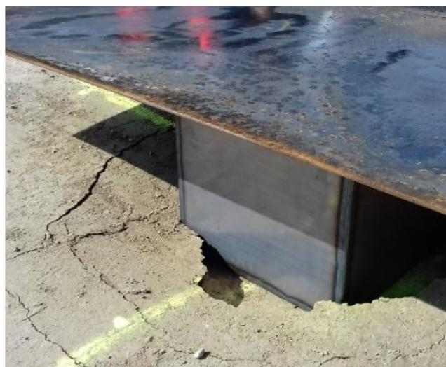
Figure 5-6. Dispositif de chargement. Effondrement du remblai de la cavité N°2, planche N°1
