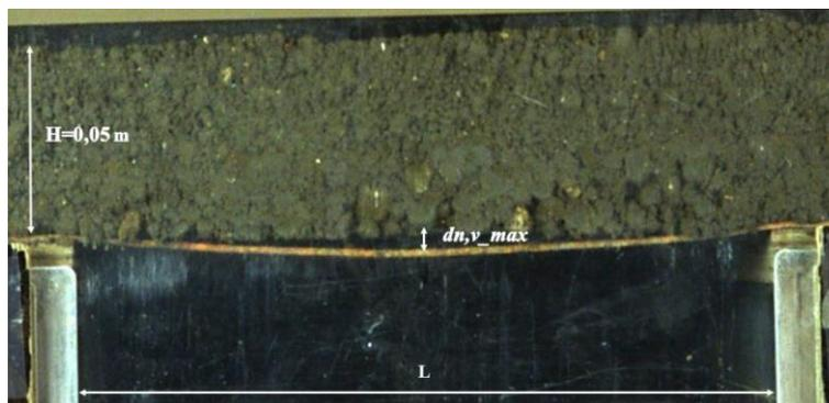
Figure 4-7. Abaissement de la trappe. Essai N°1, H=0,05 m
