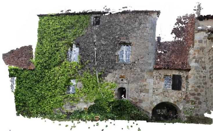
Figure 48 : Photogrammétrie d'une façade d'un bâti du corpus – cas du prieuré
