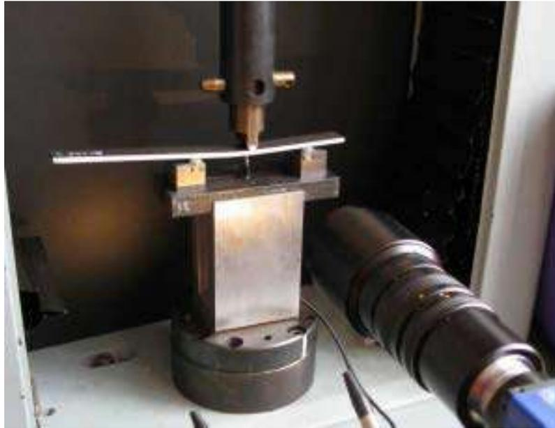
FIGURE I.29 – Essai ENF pour des composites stratifiés [24]
