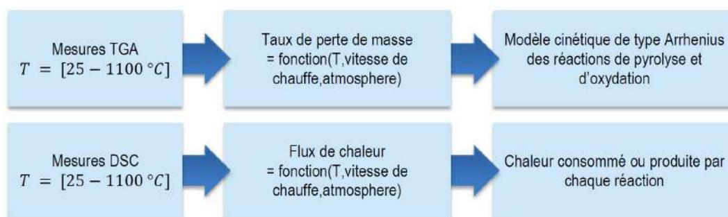
FIGURE I.7 – Principe des mesures couplées TGA et DSC [7]
