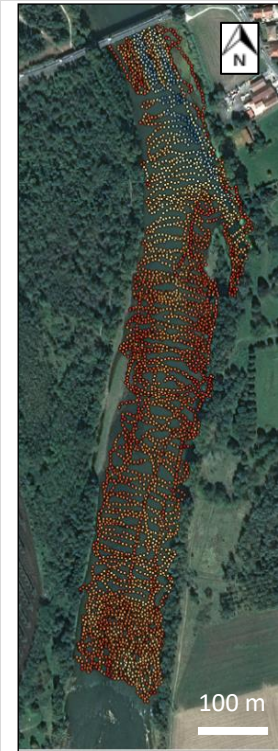
Figure 5. Relevés de bathymétrie à Seilh à l'échosondeur.
