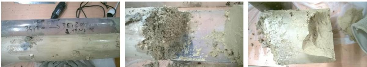
Figure 2.34 : Carotte\_34,7-36,2 dans le calcaire de St Ouen
