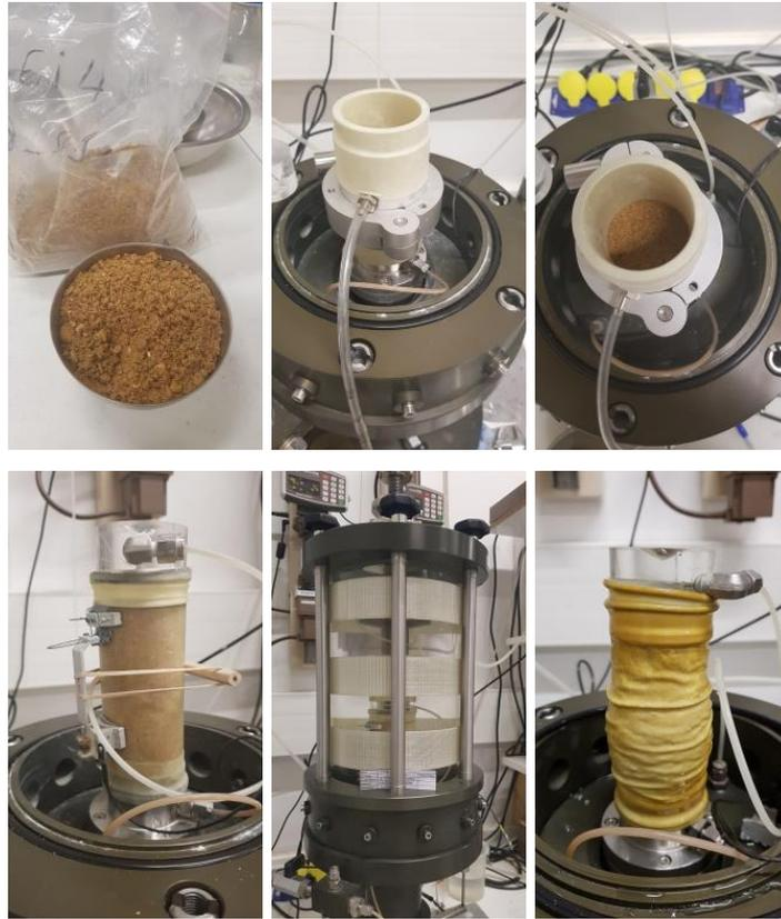
Figure 2.36 : Essai triaxial drainé sur des alluvions
