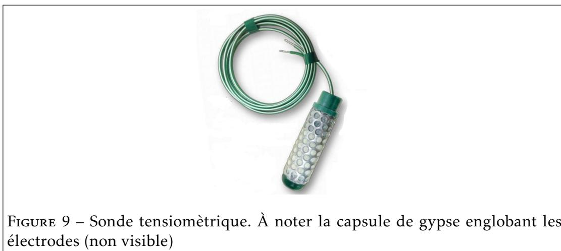
FIGURE 9 – Sonde tensiométrique. À noter la capsule de gypse englobant les électrodes (non visible)
