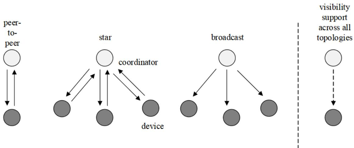
Figure II-5: Topologies des réseaux IEEE 802.15.7r1.m [73]
