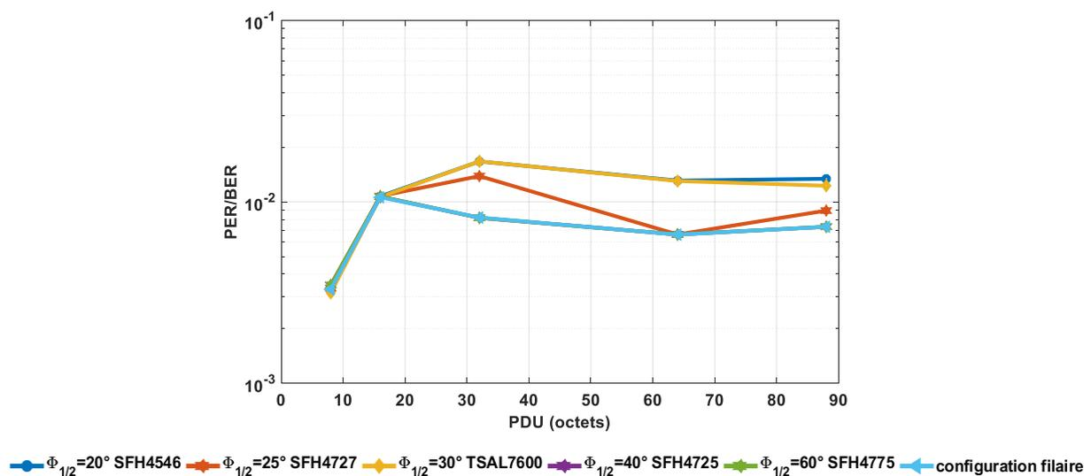
Figure V-18 : PER en fonction de la taille de la PDU pour différentes LEDs
