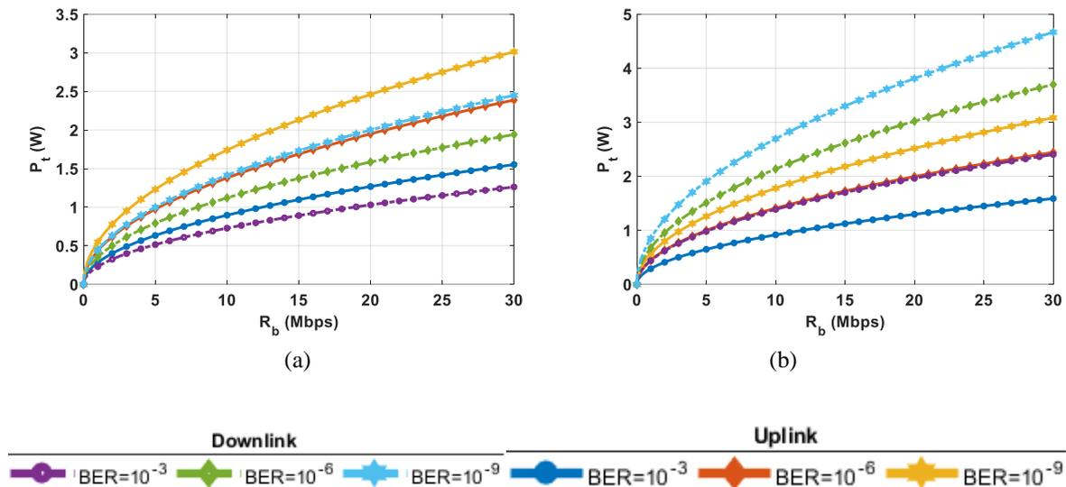
Figure IV-2 :  $P_t$  en fonction de  $R_b$ , OOK, 1Tx/Rx (a) 2 pilotes (b) 4 pilotes,  $\rho = 0,5$
