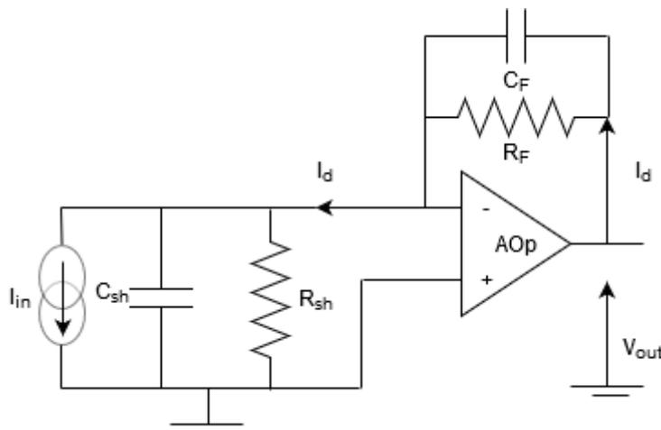
Figure III-12: Illustration du modèle équivalent d'une PD et d'un montage avec un TIA
