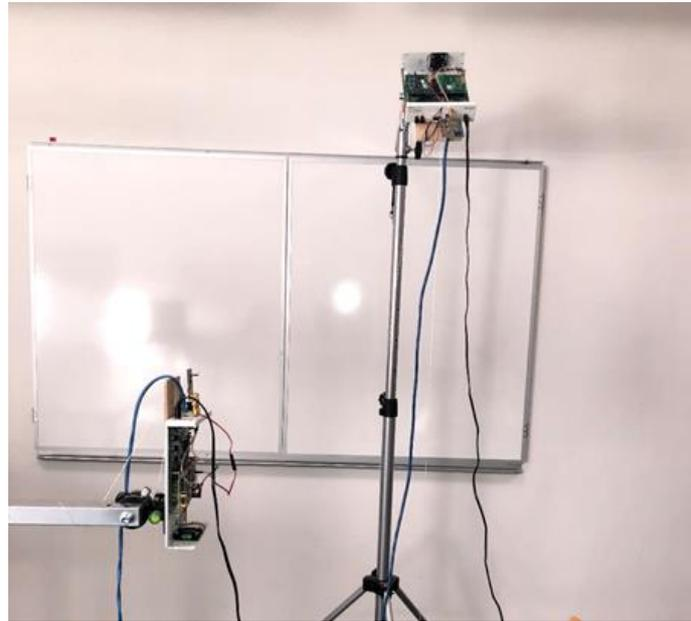
Figure V-19: Émetteur-récepteur en configuration LOS indirect - uplink
