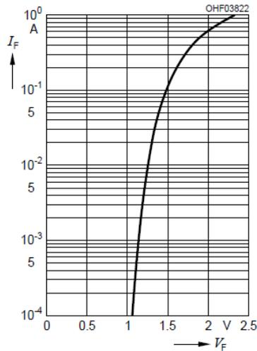
Figure III-8:  $I_F$  en fonction de  $V_F$  SFH4546 [97]
