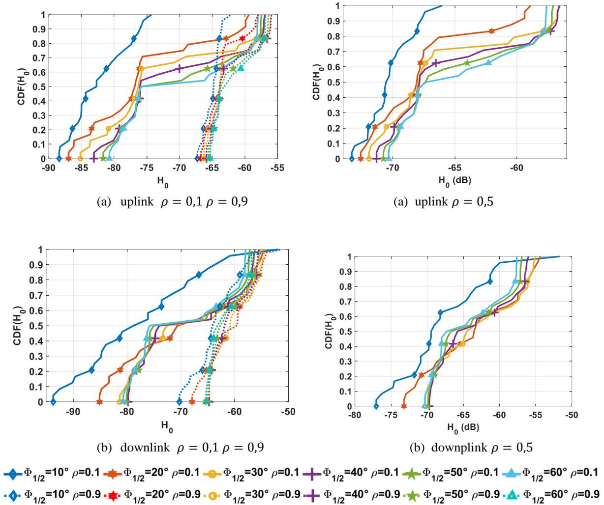
Figure III-31 : CDF du gain de la liaison en fonction de l'angle à mi-puissance pour  $\rho = 0,1; 0,5; 0,9$  pilote :
