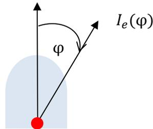
Figure III-2: Intensité lumineuse rayonnée  $I_e(\varphi) = I_0 \cos^m(\varphi)$
