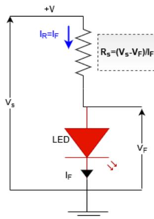
Figure III-6 : Illustration résistance  $R_S$  de protection d'une LED
