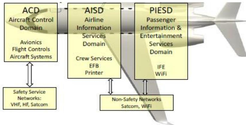
Figure I-4 : Domaines des réseaux dans les avions [29]
