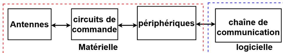
Figure V-1 : Synoptique simplifié d'un système SDR
