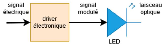
Figure III-1: Illustration simplifiée de l'émetteur
