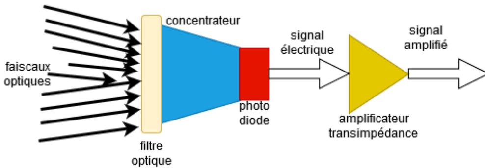
Figure III-11: Illustration simplifiée d'un récepteur à photodiode
