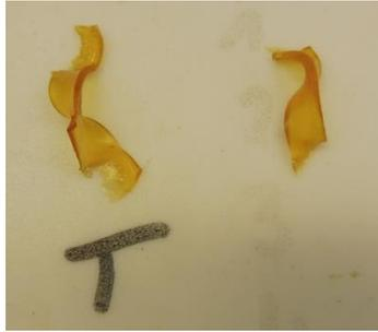
**Figure 4-29 :** Matériaux hybrC (1 : 2) témoin noté « T » (à gauche) et ayant subi les conditions d'humidité élevée (50 °C, 50% HR, 24 heures) (à droite) suite à une déformation imposée.
