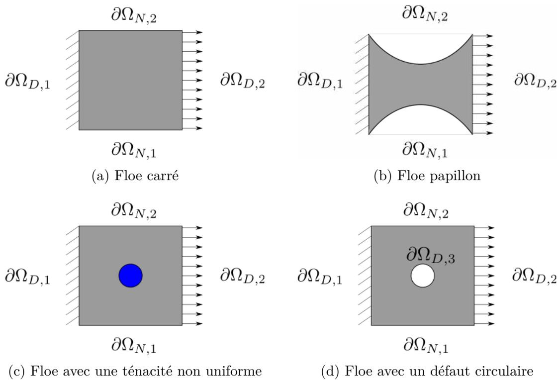
FIG. 2.4 : Différentes géométries utilisées
