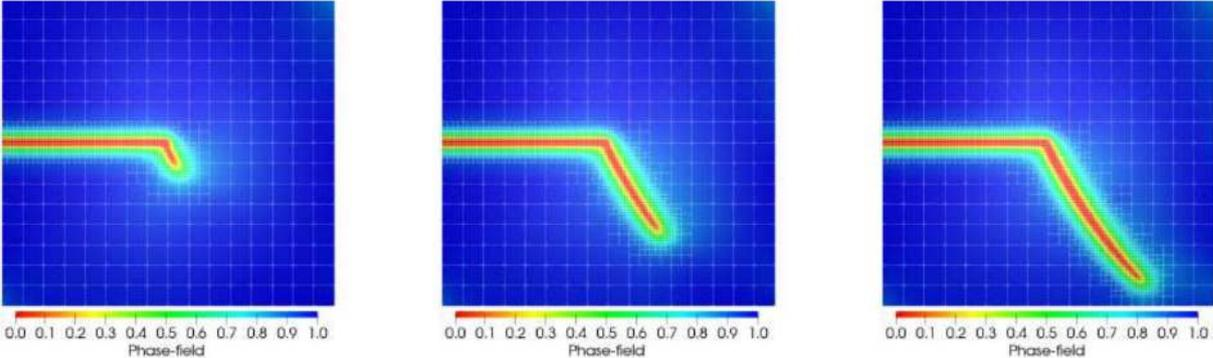
FIG. 1.2 : Bifurcation d'une fracture - Modèle Phase Field
