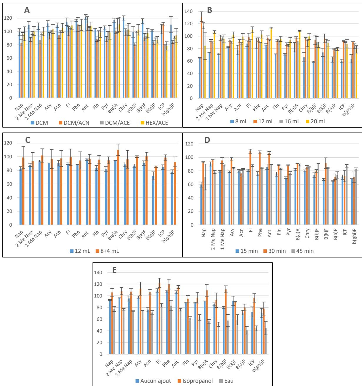
Figure 2.5: les rendements d'extraction de 17 HAPs à partir de sol dopé à 150 ng.g<sup>-1</sup> pour les différents paramètres optimisés: (A) le solvant d'extraction, (B) le volume de solvant, (C) le fractionnement du solvant, (D) la durée d'extraction et (E) l'effet de l'eau et l'isopropanol.
