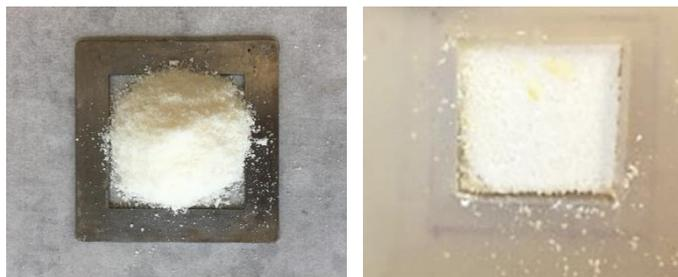
**Figure IV- 45.** *Recyclabilité de l'hybride IVA : 2,2Ti sous presse à compression à 130 °C à 100 bar pendant 15 minutes à partir de poudres*
