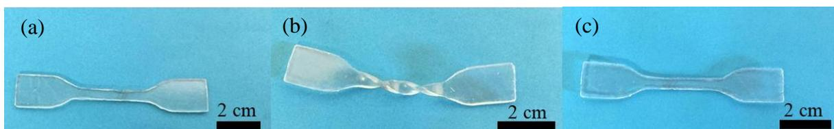
**Figure IV- 1.** *Expérience de mémoire de forme pour le matériau témoin EVA-DCP*
