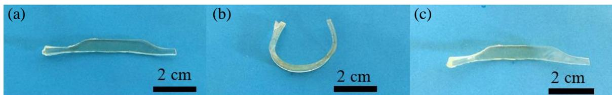
**Figure IV- 5.** *Expérience de mémoire de forme pour le matériau hybride IVA : 0,44Ti en présence de 40 % d'acétates de vinyle (a) forme permanente (b) forme temporaire stable obtenue sous contrainte en chauffant (c) forme recouvrée en chauffant sans contrainte*
