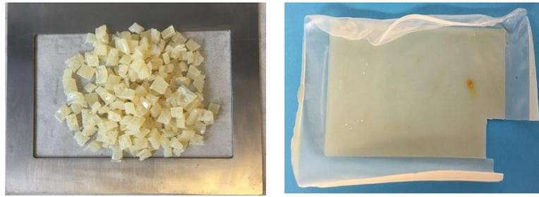
**Figure IV- 39.** Recyclabilité de l'hybride IVA : 0,1Ti sous presse à compression à 130 °C à 100 bar pendant 15 minutes à partir de morceaux découpés
