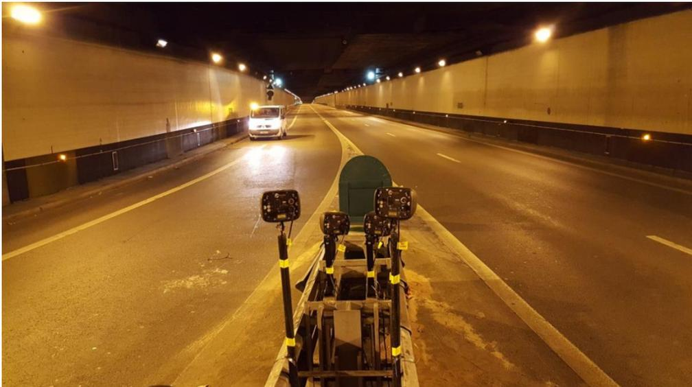
Figure 14 : Caméras utilisées par la société AlyceSofreco.
