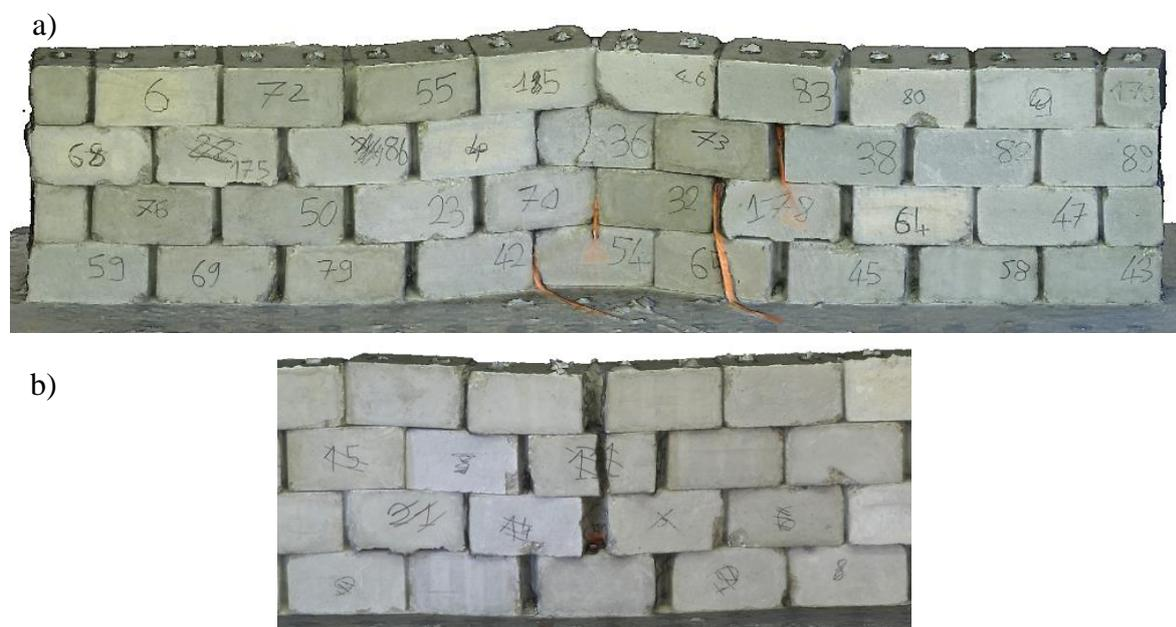
Figure 3.29 : Mur droit après impact à 1 040 J pour  $H_i = 0,5$  m a) déformation générale du mur
