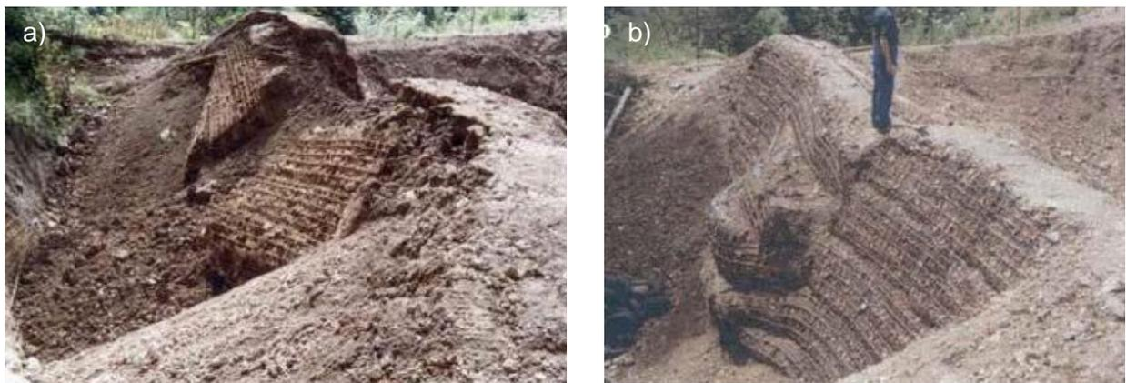
Figure 2.9 : Déformation de la face aval après impact a) d'un ouvrage non renforcé b) d'un ouvrage renforcé
