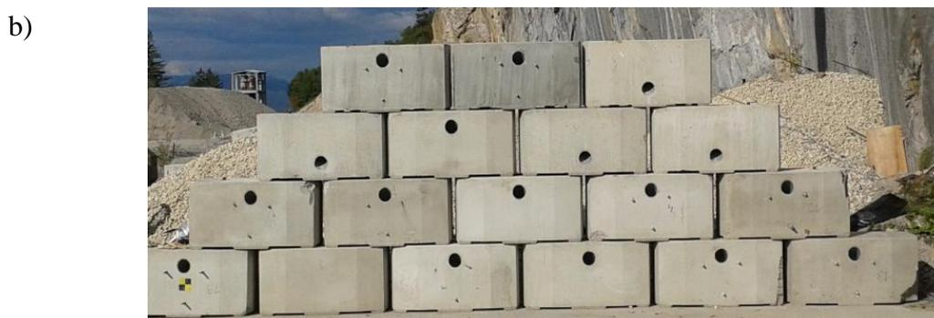
Figure 1.5 : Bloc Armé a) principe de la solution b) mur test avant impact
