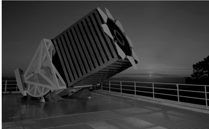
FIGURE 3.2: Le télescope de 2.5m de type Richey-Chrétien modifié est localisé à Apache Point Observatory dans l'état du Nouveau-Mexique (États-Unis). Spécialement construit pour le relevé SDSS, il est opérationnel depuis 1998. Source : <https://www.sdss.org/education/sdss-telescope-small/>
