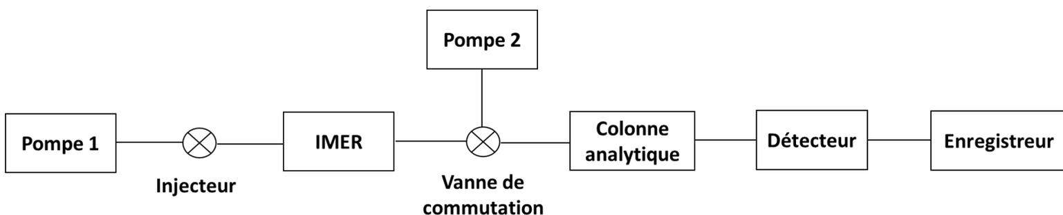
**Figure 12** IMER en position pré-colonne: une seconde pompe connectée à une vanne de commutation permet de modifier la phase mobile après la réaction enzymatique.
