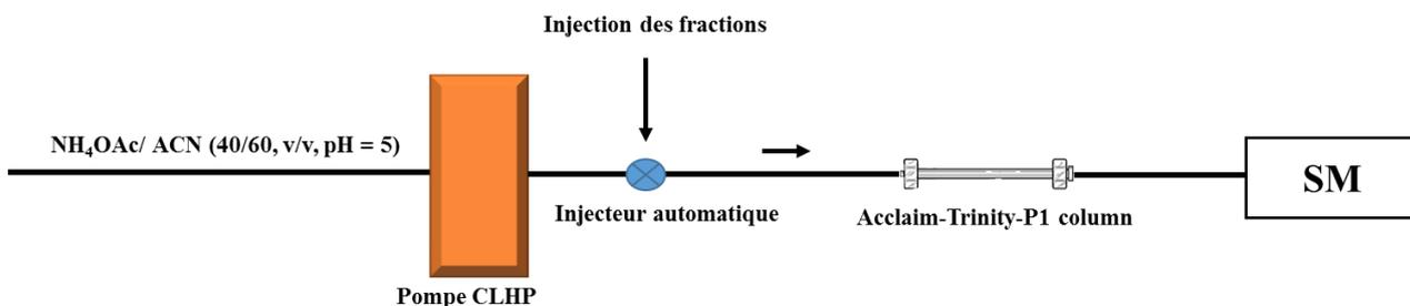
**Figure 20** Couplage chromatographique CLHP-SM destiné à l'analyse des fractions collectées.
