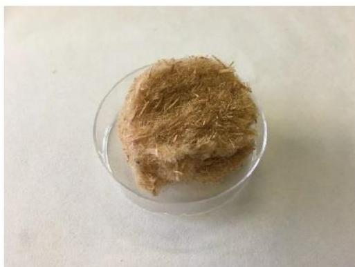
Figure 2-3. Exemple : éprouvette de l'isolant A (fibres de bois)
