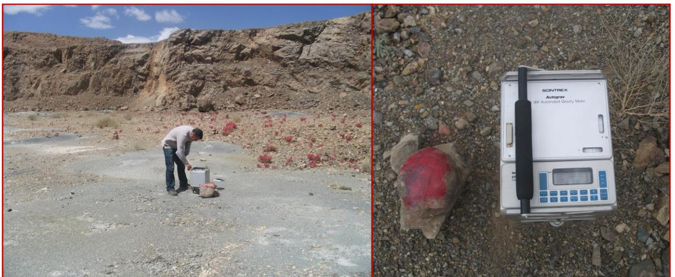
Figure 4-7: Levé microgravimétrique à l'aide du gravimètre CG-3M Autograv Meter.
