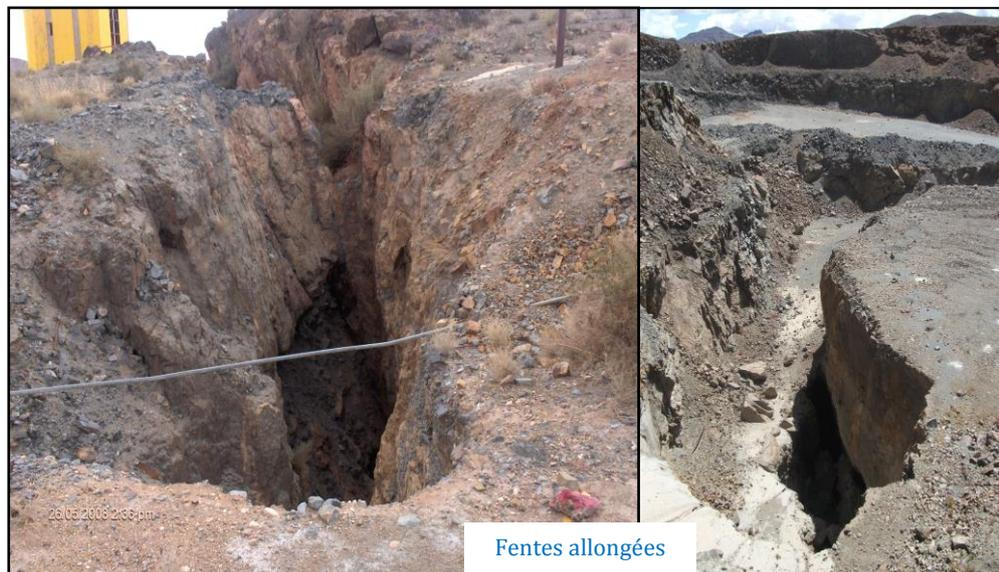
Figure 4-4: Exemples de cavités et de fentes anciennes dans la mine d'Imiter.
