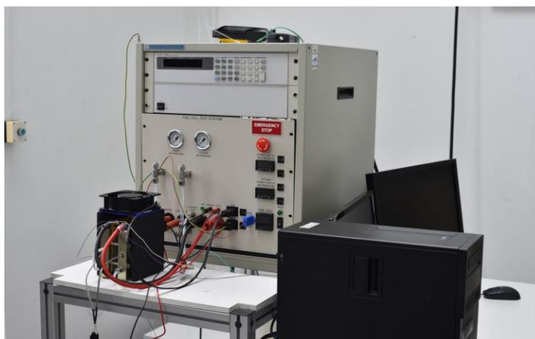
**Figure 62** Banc d'essai FCT du laboratoire LE2P avec sa monocellule
