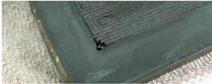
**Figure 66** Photographie d'une destruction de la MEA à l'entrée de la monocellule
