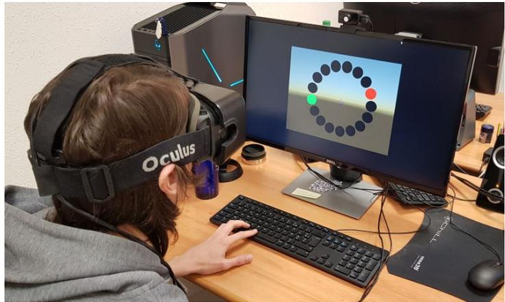
FIGURE 3.4 – *Expérimentation permettant de déterminer la différence entre la direction de la tête et celle du regard avec un casque de réalité virtuelle*
