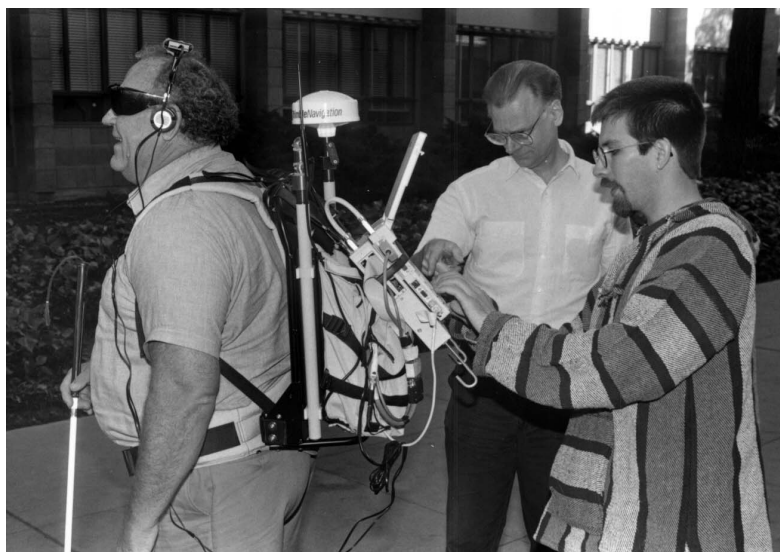
FIGURE 2.10 – Le Personal Guidance System de Loomis et al. (photo prise sur le site du système : http://www.geog.ucsb.edu/pgs/main.htm (accès le 13 septembre 2019)).
