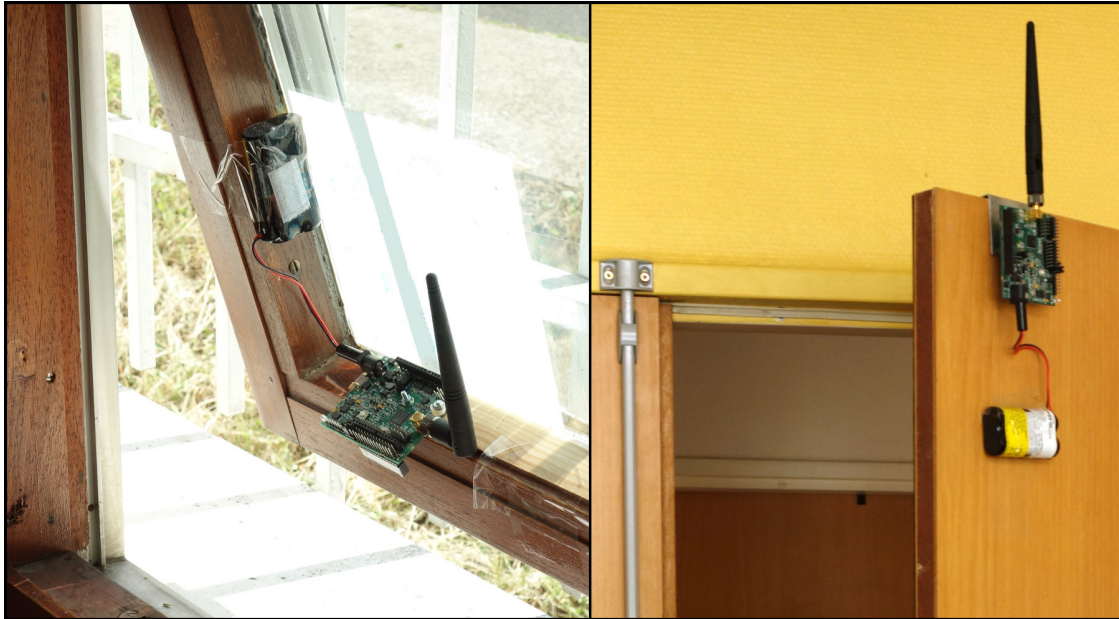
FIGURE 4.9 – Maquettes d’objets : à gauche, la fenêtre intelligente ; à droite, la porte intelligente.
