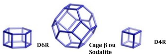
Figure 1.14 – Exemples d'unités secondaires (SBU) dont l'assemblage va servir à construire les zéolithes de type LTA, FAU et SOD[58].
