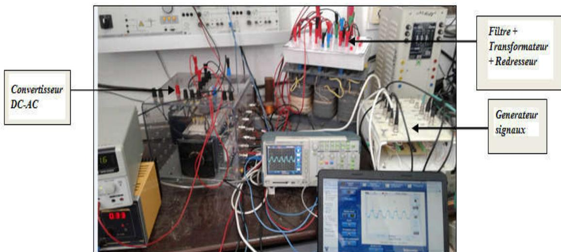
Figure (4. 26) : Maquette expérimentale du convertisseur DC/DC à résonance parallèle
