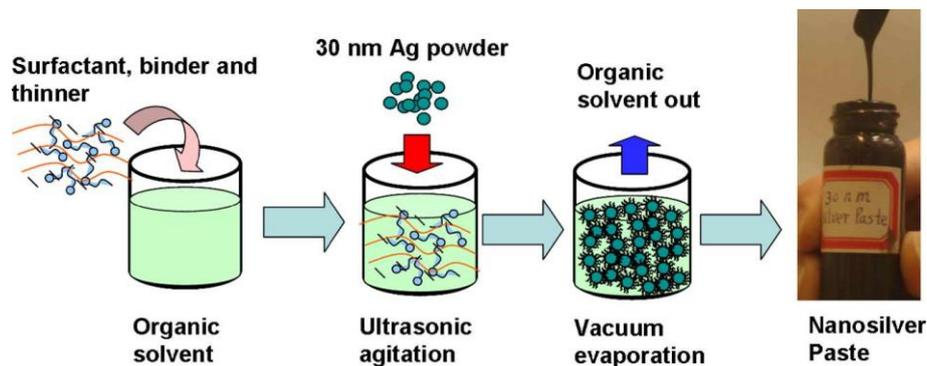
Figure 19 : Schéma de formulation d'une nanopâte d'argent par évaporation d'un solvant à basse température d'ébullition [64].
