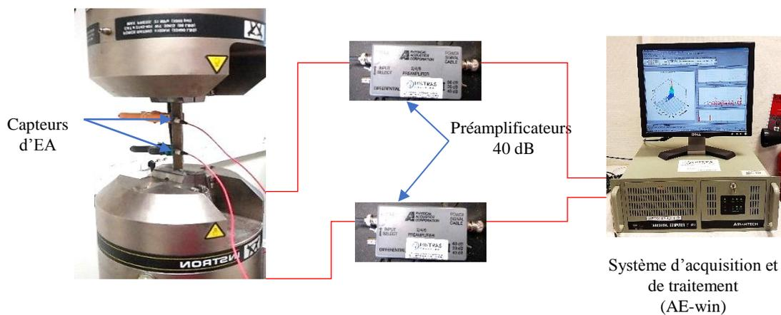
**Figure 3.4** – Dispositif expérimental de la technique d'émission acoustique.
