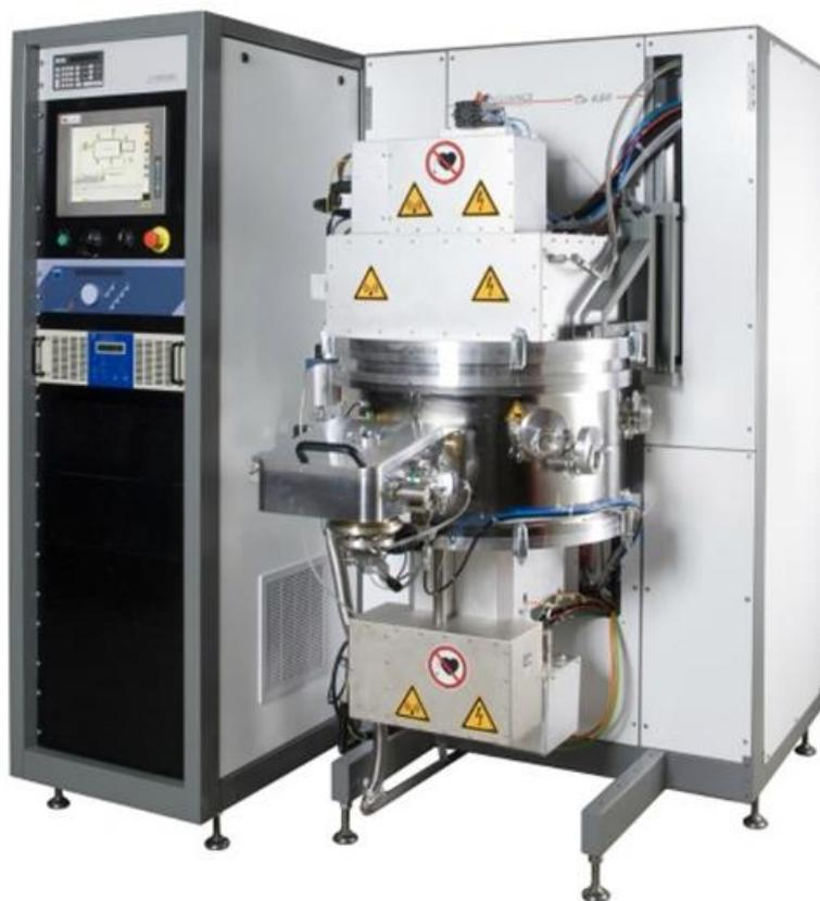
Figure 3 : Bâti de pulvérisation cathodique utilisé (IEMN, Lille)
