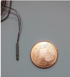
FIGURE 4.16 – Capteur de pression miniature
