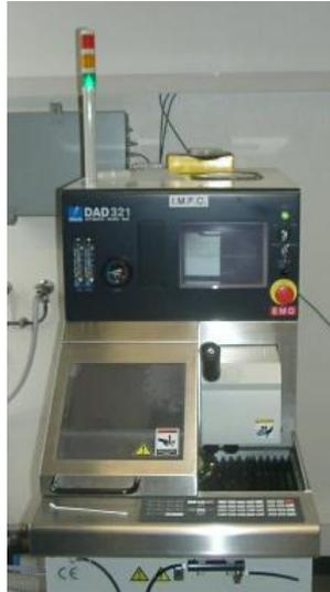
FIGURE 2.21 – Scie de précision de type DISCO DAD 321
