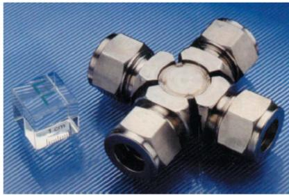
FIGURE 1.38 – Micro-échangeur métallique à courants croisés [18]
