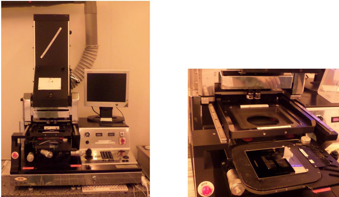
FIGURE 2.15 – Aligneur de masques double-face à contact de type EVG620
