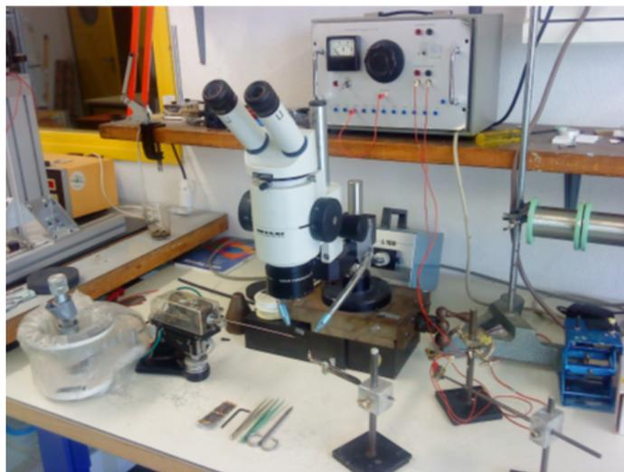
FIGURE 4.24 – Banc de soudure microthermocouple par décharge capacitive [?]
