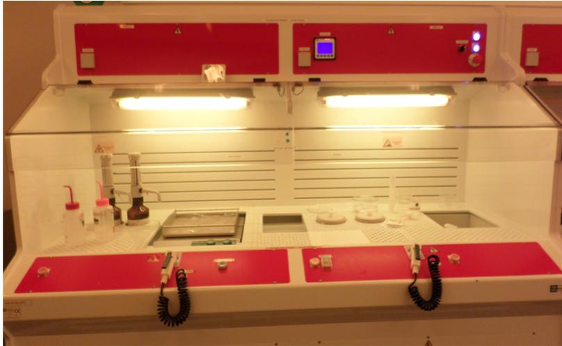
FIGURE 2.9 – Banc de nettoyage du wafer
