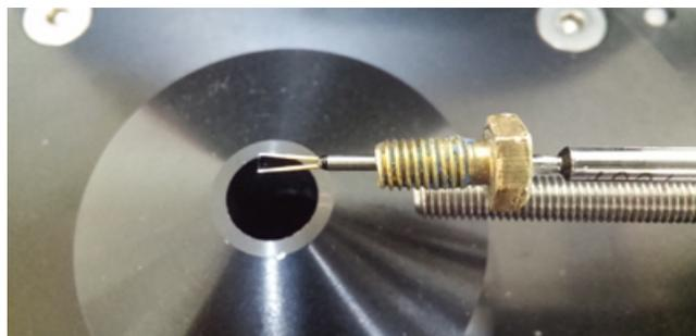
FIGURE 4.18 – Capteur à fil chaud montée sur le banc de calibration
